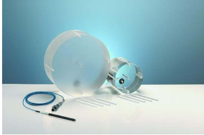
Şekil 3: 16 cm ve 32 cm çapında standart CTDI fantomları ve 100 mm uzunluğunda kalem iyon odası dedektörü.
