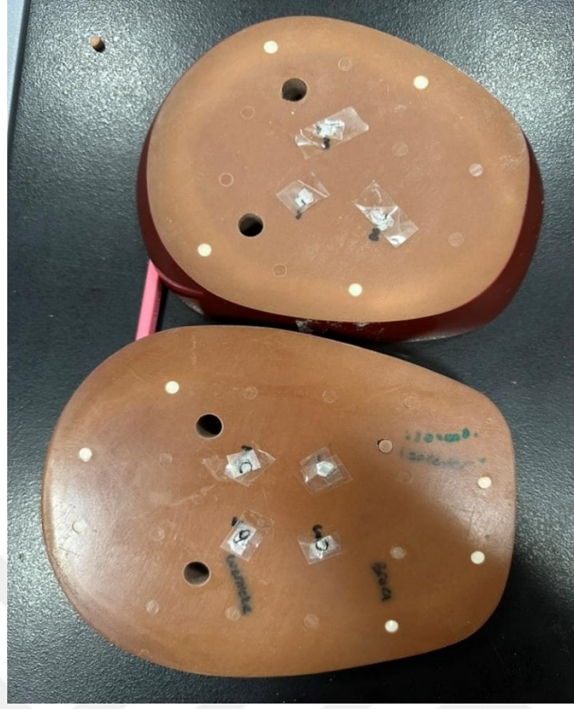
Şekil 6.12. Beyin anatomik anatomik bölgesine yerleştirilen TLD çipleri ile deneysel dozimetri uygulaması
