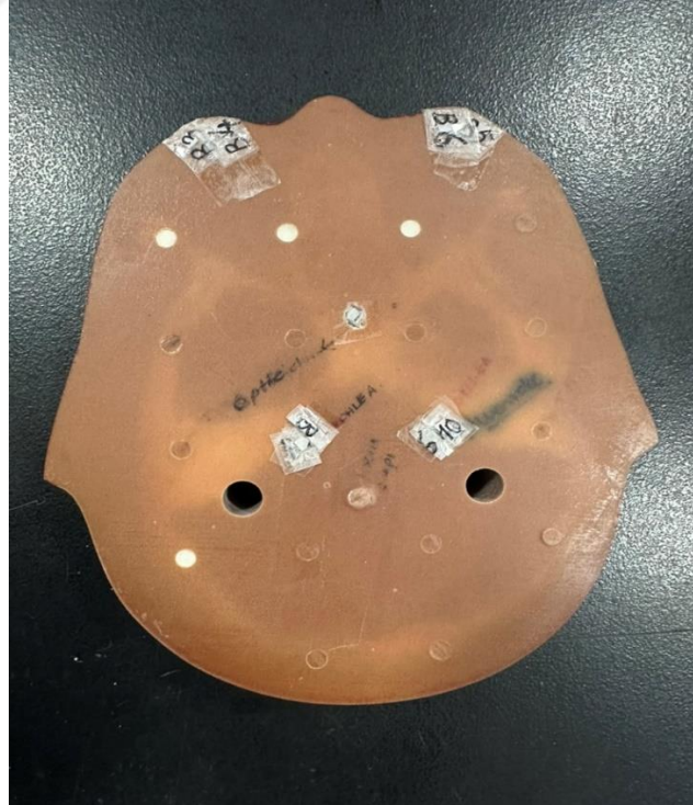
Şekil 6.11. Koklea bölgesine yerleştirilen TLD çipleri ile yapılan doz ölçüm düzeneği
