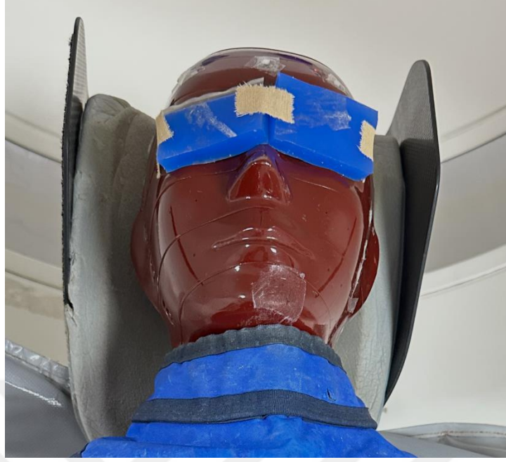
Şekil 6.14. Lens dozunu azaltma potansiyeli araştırılan bolus materyalinin deneysel uygulaması
