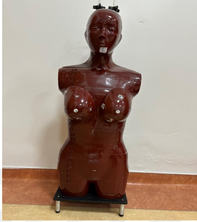
Şekil 6.10. AldersonRando Fantom: radyasyon doz dağılımı ölçümlerinde kullanılan referans model
