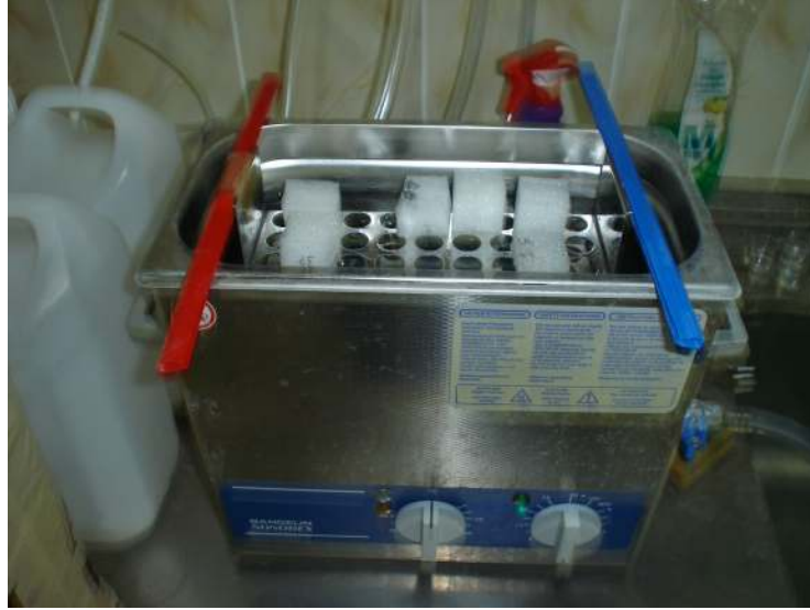
Şekil 3.4 Kristallerin Ultrasonik Banyoda Temizlenmesi
