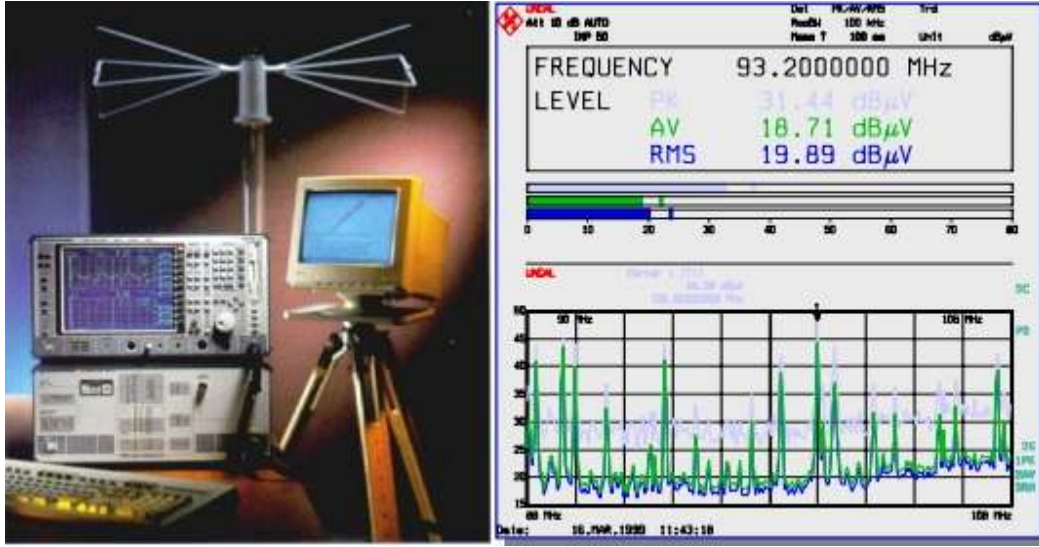
Resim 2.12.a. TEMPEST alıcısı ve kaydedilen işaret örneği[47].
