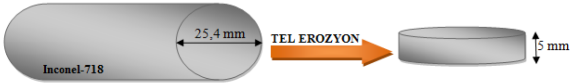
Şekil 33: Disk şeklindeki altlık malzemenin tel erozyon yöntemi ile hazır hale getirilmesi.
