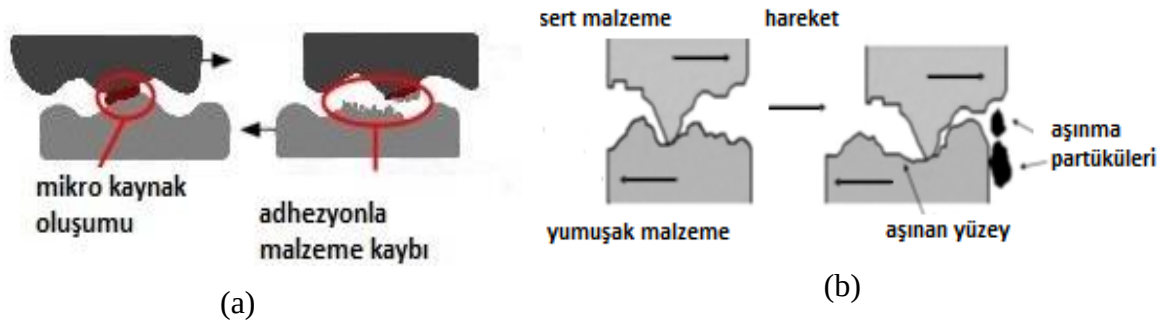
Şekil 2.12. (a) Adhesif aşınma, (b) abrazif aşınma mekanizmaları
