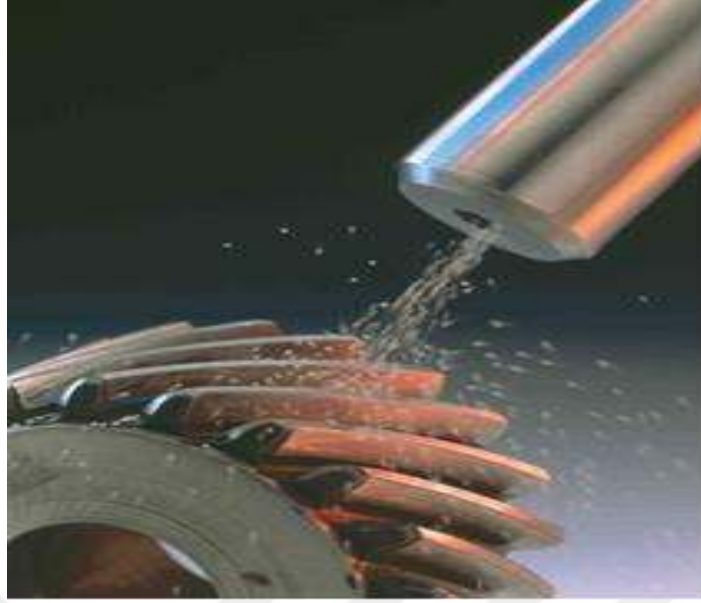
Şekil 3.2 Bilyeli yüzey dövme işleminin gösterimi [34].
