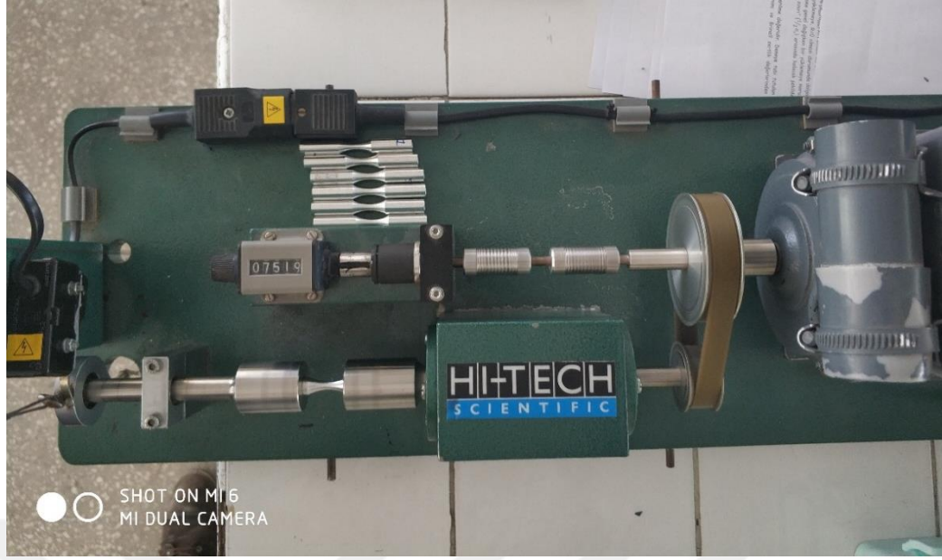
Şekil 5.5 Yorulma test cihazına yorulma numunesinin bağlanması
