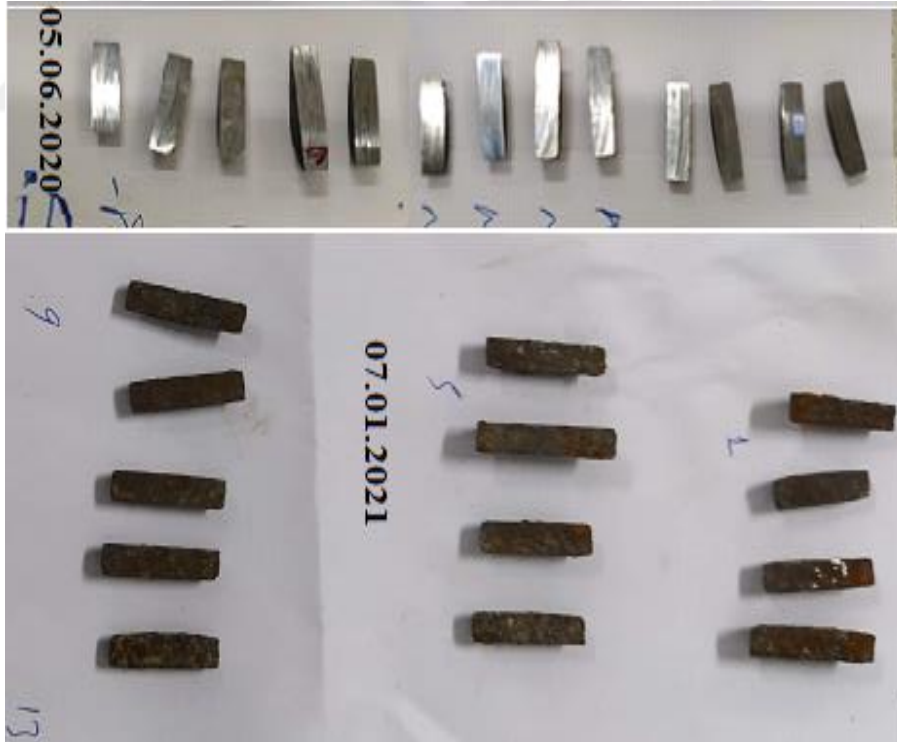
Şekil 4.26. Korozyon dayanımı ölçümlerinde kullanılan 13 farklı numunenin ilk ve son durumları gösteren resimler
