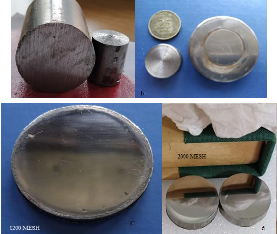
Şekil 3.1. a) Silindir tipi çelikler, b) Dilimlenmiş hedef metaller, c) Yüzeyin 1200 mesh zımpara ile parlatılmış hali, d) Yüzeyin 2000 mesh zımpara ile parlatılmış hali
