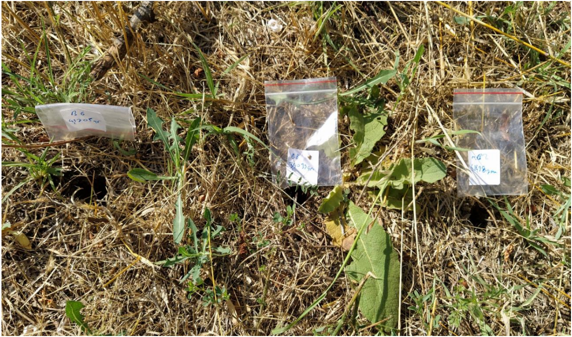
Şekil 3.16. Koroziyon dayanım için numunelerin gömüldüğü doğal alan (TOGÜ Fen Edebiyat Fakültesi ön bahçesi)
