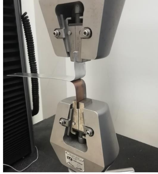
Şekil 5.22. ASTM D1876-08(2015) soyulma test numunesi ölçüleri ve soyulma testinin yapılması
