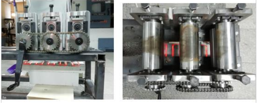
Şekil 5.14. Rulo yapıştırma makinesi hadde silindirlerinin ısıtılması
