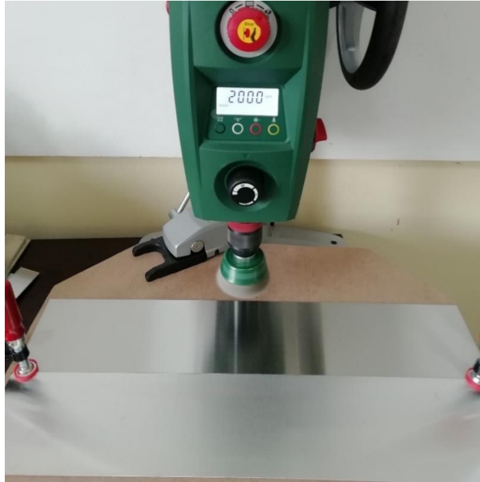
Şekil 5.10. Sac levhaların paslanmaz tel fırça ile polisajlanması işlemi
