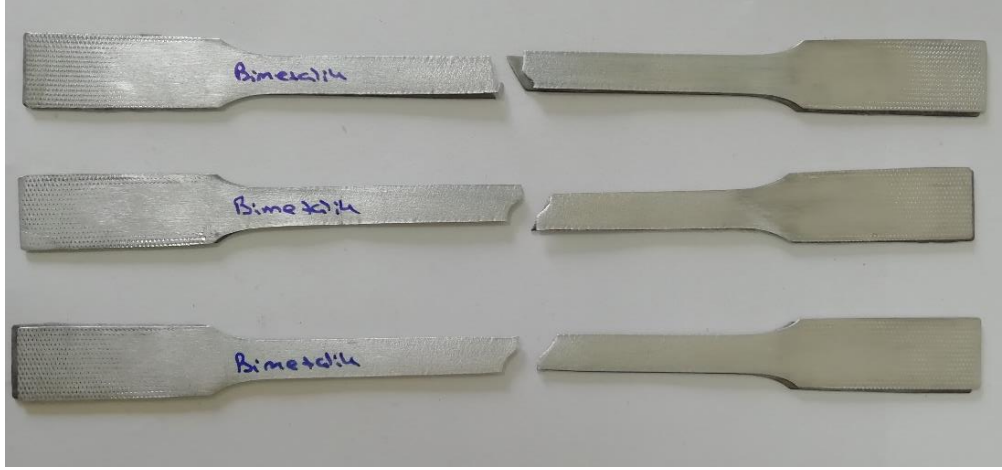
Şekil 6.7. Çift katmanlı Al 1050-304 paslanmaz çelik çekme testi sonucu kopan numune görselleri
