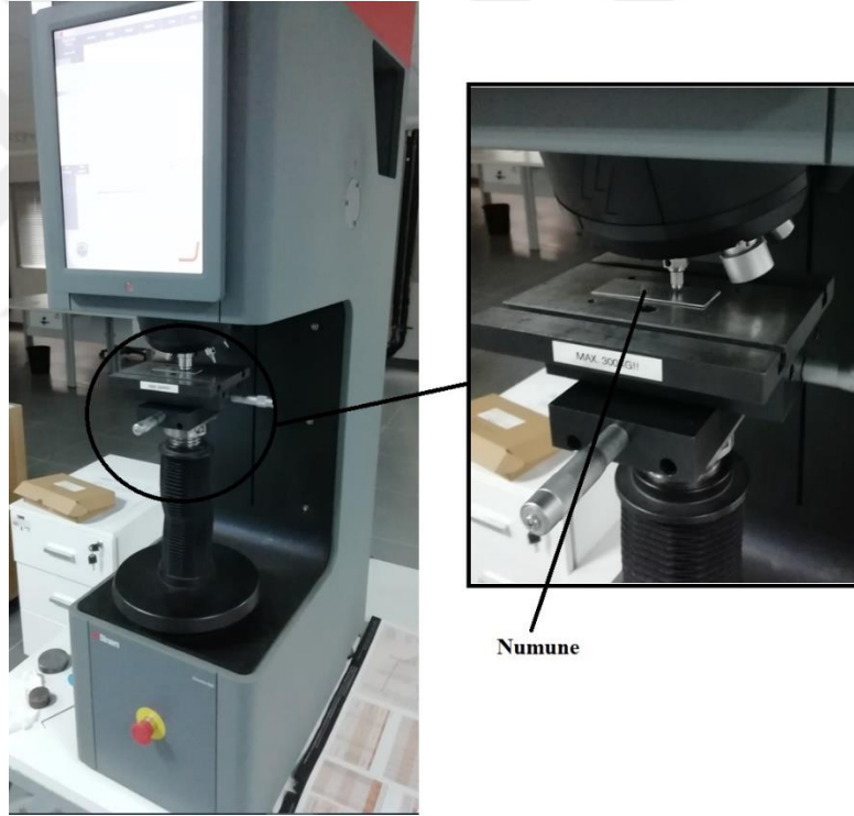
řekil 5.20. Brinell sertlik lm cihazı ve sertlik lm
