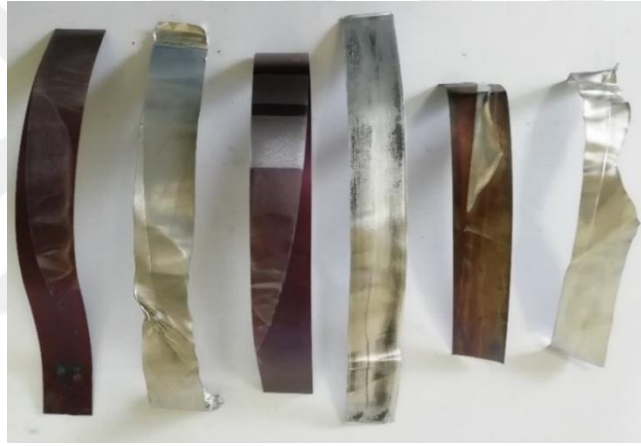
Şekil 6.9. Çift katmanlı Al 1050-304 paslanmaz çelik soyulma testi sonucu ayrılan numune görselleri
