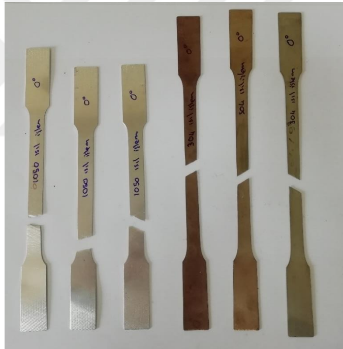
Şekil 6.4. Isıl işlem sonrası Al 1050 ve 304 paslanmaz çelik malzemelerin çekme test sonucu kopan numune görselleri
