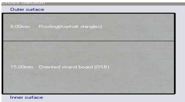
Şekil 55. Kullanılmayan çatı aralı bina modelinin FDM'siz çatı kesiti tip-2
