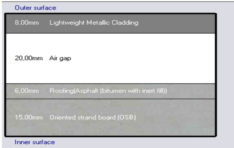
Şekil 56. Kullanılmayan çatı aralı bina modelinin FDM'siz çatı kesiti tip-3
