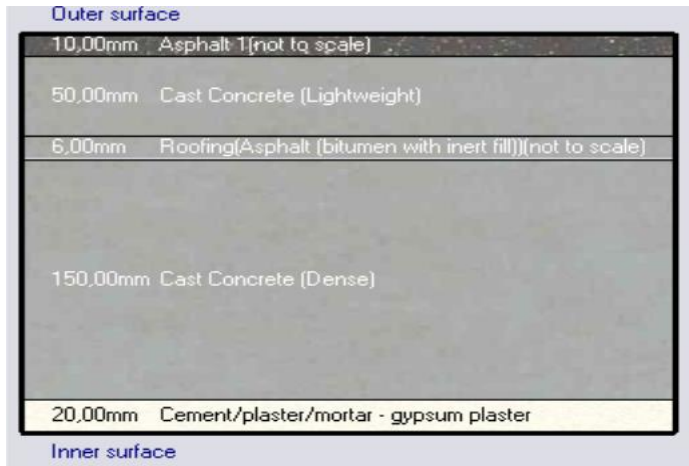
Şekil 28. Teras çatıda belirlenen FDM'siz çatı kesiti tip-3
