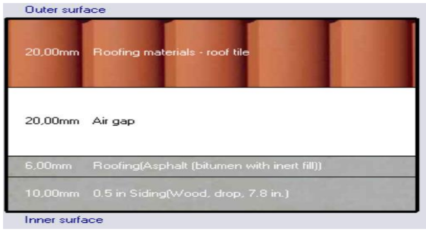
Şekil 63. Kullanılan çatı aralı bina modeli için belirlenen FDM'siz çatı kesiti tip-1
