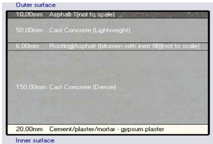
Şekil 28. Teras çatıda belirlenen FDM'siz çatı kesiti tip-3
