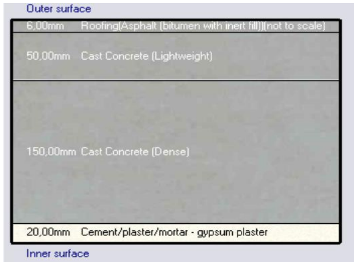
Şekil 26. Teras çatıda belirlenen FDM'siz çatı kesiti tip-1
