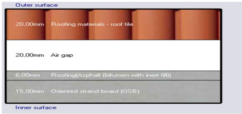
Şekil 54. Kullanılmayan çatı aralı bina modelinin FDM'siz çatı kesiti tip-1
