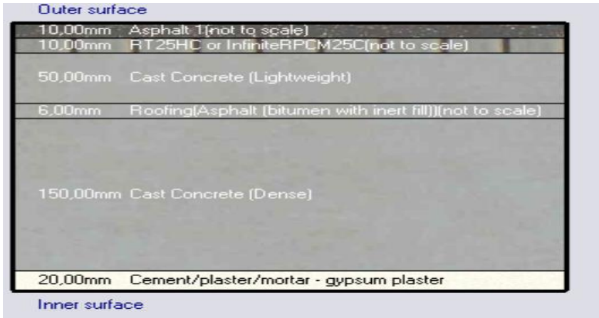
Şekil 33. Teras çatıda belirlenen FDM’li çatı kesiti tip-2
