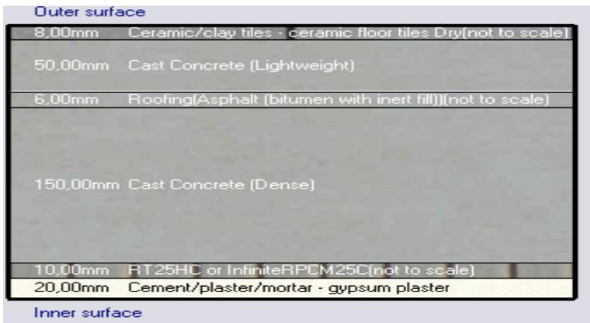
Şekil 34. Teras çatıda belirlenen FDM’li çatı kesiti tip-3
