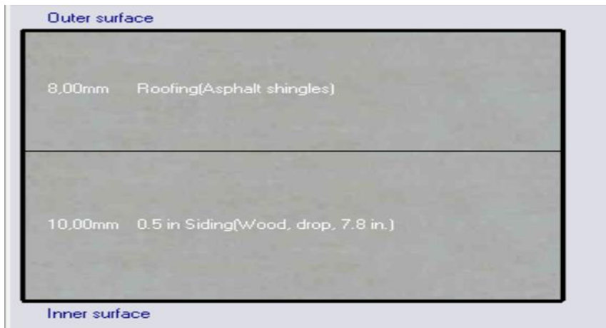
Şekil 64. Kullanılan çatı aralı bina modeli için belirlenen FDM'siz çatı kesiti tip-2
