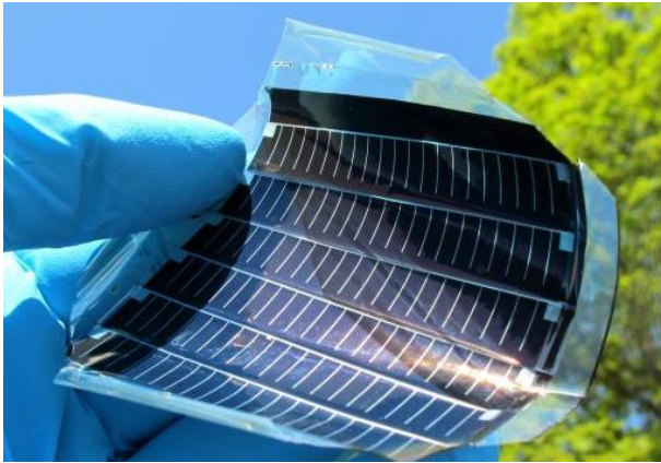
Şekil 20. Kadmiyum tellür FV hücre (URL-3, 2011).
