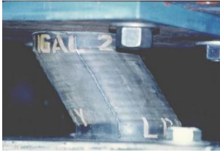
Şekil 1.8. Kurşun çekirdekli kauçuk izolatörün yatay deplasmanı (Kalpakidis ve Constantinou, 2009).
