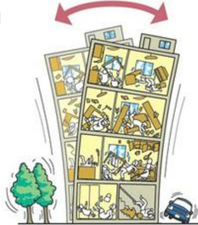
Şekil 1.2. Deprem sırasında normal yapı davranışı (Kurashiki, 2019).
