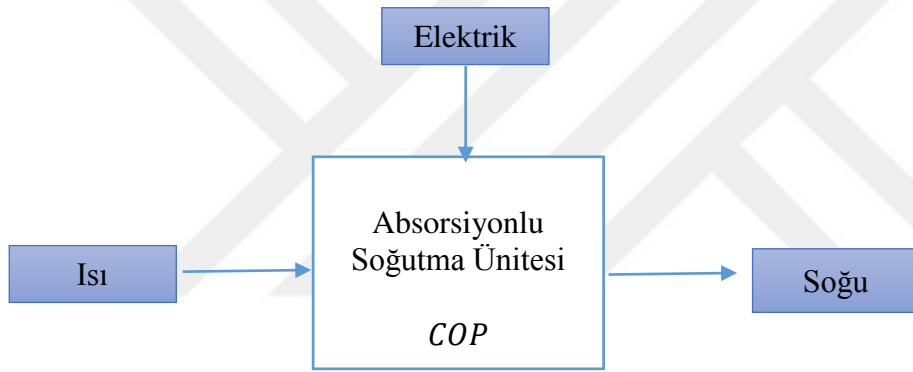
Şekil 2.6 Absorpsiyonlu soğutma sistemi kara kutu gösterimi
