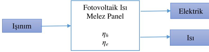
Şekil 2.15 Fotovoltaik ısı melez panel kara kutu gösterimi
