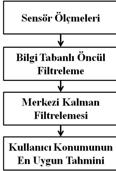
Şekil 3.11 : Çoklu Sensör Birleşim Modeli Akış Diyagramı (Retscher, 2006).
