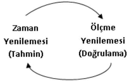
Şekil 4.3 : Kalman Filtresi algoritma döngüsü.
