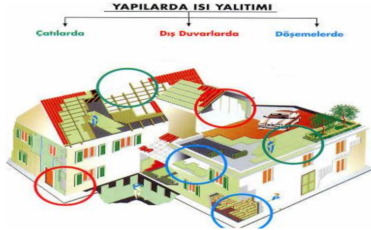
Şekil 5.2. Binalarda yalıtım uygulanan yüzeyler (Akıncı, 2007).
