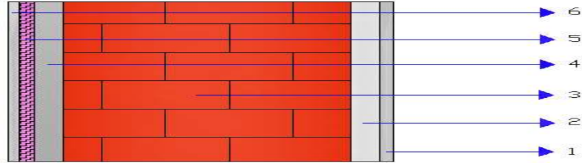
Şekil 8.7. 1 cm XPS ile yalıtılmış dış ortama açık duvar (tuğla) detayı.
