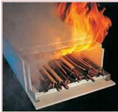
Şekil 4.9. Kablo kanallarında alçı levha [18]
