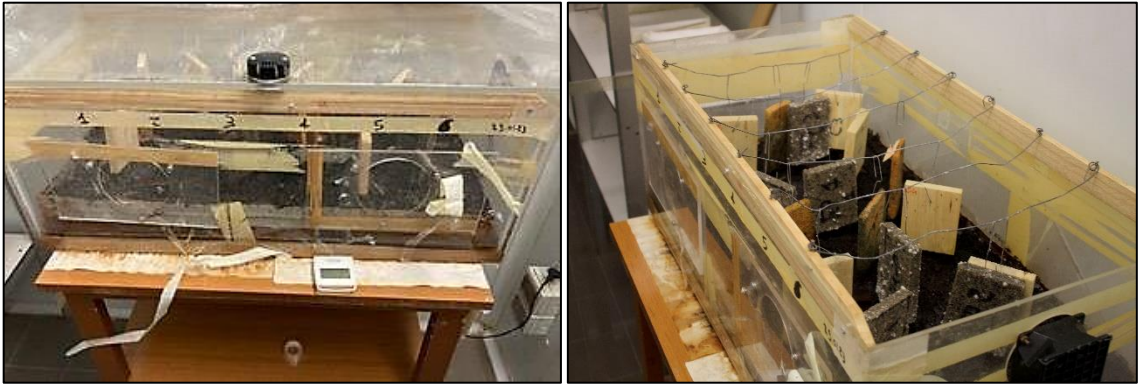
Şekil 35. Biyokompozitlerin küfe karşı direncini değerlendirmek için tasarlanmış pleksiglas kutu
