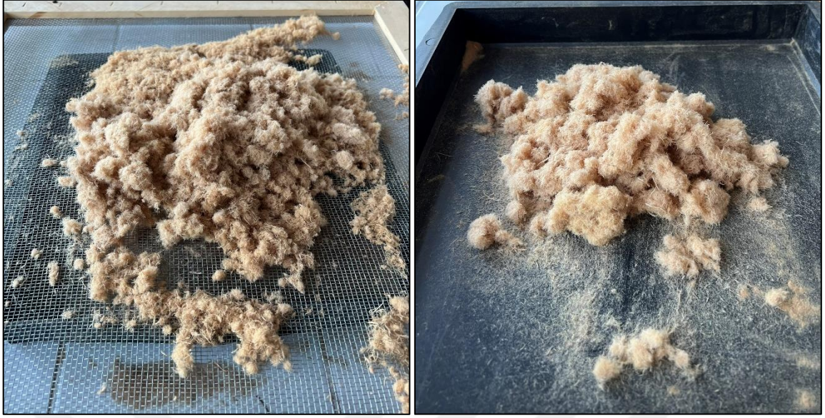
Şekil 17. Elek yardımıyla lif topaklarının açılması
