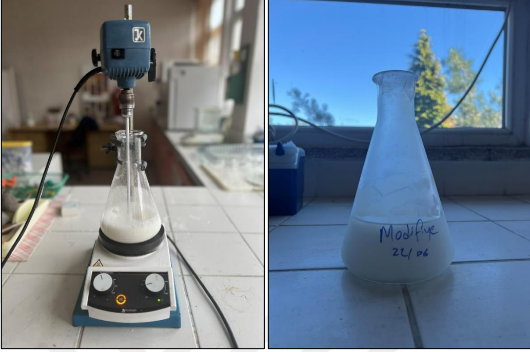
Şekil 20. Nişasta tutkalını hazırlama düzeneği
