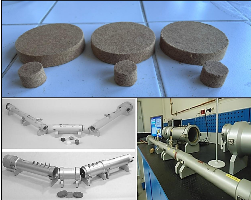
Şekil 33. Empedans tüpü test cihazıyla ses yutum katsayılarının ve ses iletim kaybının belirlenmesi
