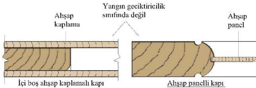
Şekil 5.24. Yalıtımsız ahşap kapı [15]
