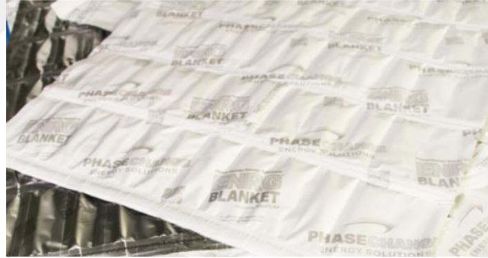
Şekil 3.19. İçerisinde FDM bulunan örtü katmanı
