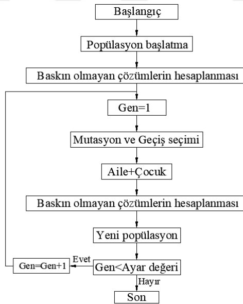
Şekil 3.25. NSGA II algoritmasının çalışma süreci
