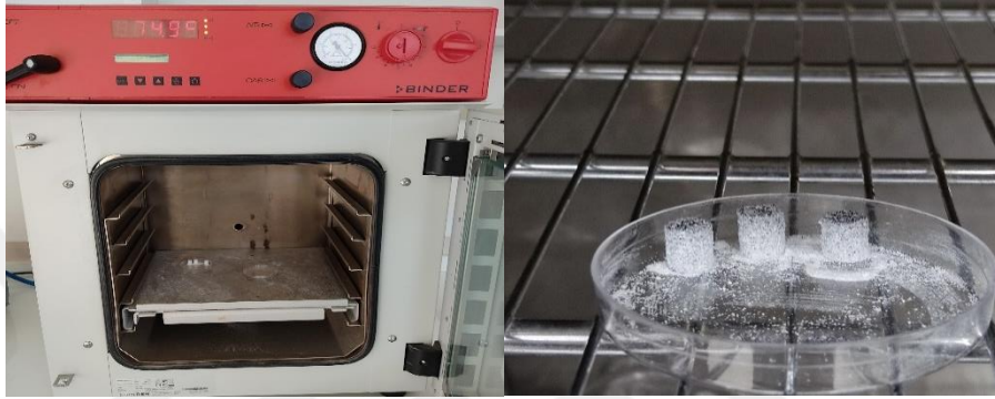
Şekil 3.8. Binder Jetting yöntemiyle üretilen numunelerin ön sinterleme işleminin yapıldığı fırın ve numuneler.
