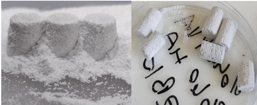
Şekil 3.7. Binder Jetting yöntemiyle üretilen numunelerin fazlalık tozlarından arındırılmadan önceki hali ve arındırıldıktan sonraki hali.
