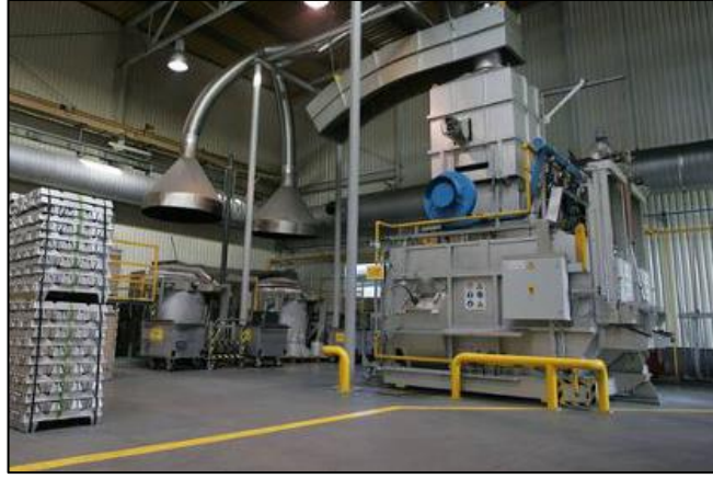
Şekil 2.7 Alüminyum külçelerin eritildiği alüminyum ergitme fırını (Industrialheating, 2019)
