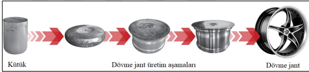
Şekil 2.2 Dövme jant üretim prosesi (Alexrims-Wheels, 2019)
