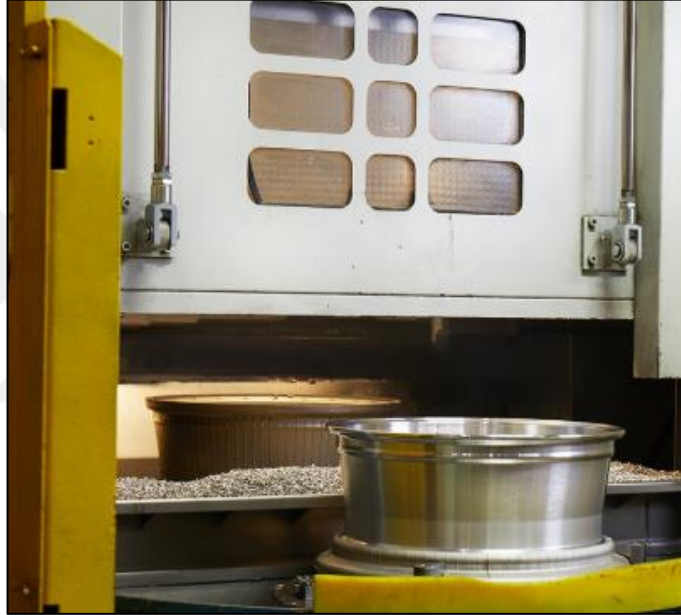
Şekil 2.11 Alüminyum alaşımlı janta uygulanan ilk talaş operasyonu (Cevher Jant, 2019)
