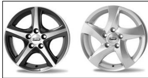
Şekil 2.13 Ön yüzey işlenmiş (sağ) ve ön yüzey işlenmemiş (sol) jant (CMS, 2019)
