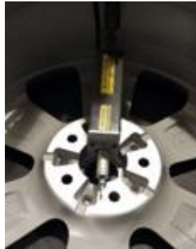
Şekil 3.13 Model jantın ofset yüzey pürüzlülük ölçümü (Kişisel arşiv, 2019)
