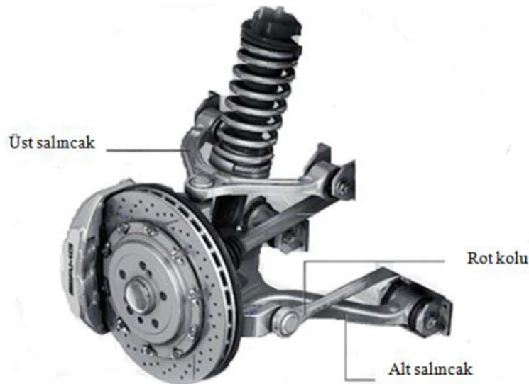
Şekil 3.11 Çift salıncaklı süspansiyon sistemi (Putgül ve Altıparmak 2016).
