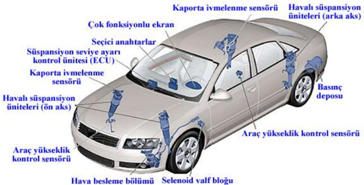
Şekil 1.11 Aktif süspansiyon sisteminin binek araç üzerindeki yeri (MEB 2013).
