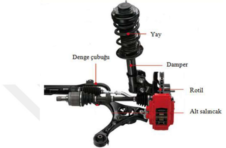
Şekil 3.10 MacPherson süspansiyon sistemi (Putgül ve Altıparmak 2016).
