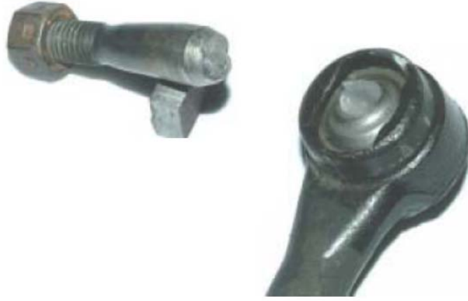
Şekil 4.2 Mafsal mili boyun bölgesinden kırılmış bir rot başı (Falah, Alfares ve Elkholy, 2007)
