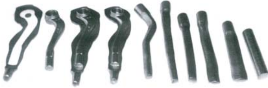
řekil 2.8 Radyal gövdenin dövme aşamaları (Heissing ve Ersoy, 2011)
