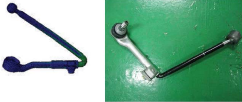
Şekil 1.2 Rotun burkulma analizi ve test sonucu (Park ve diğer., 2014)
