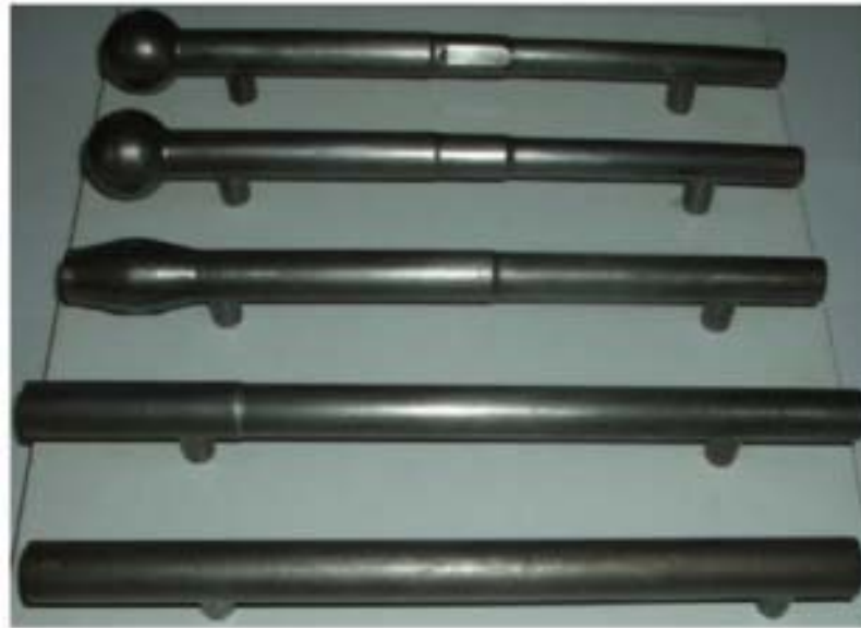
Şekil 2.6 Eksenel mafsalları dövme aşamaları (Heissing ve Ersoy, 2011)
