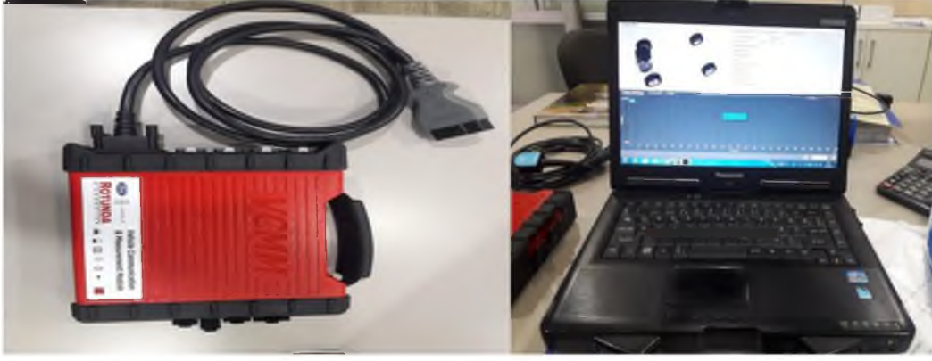
Şekil.2.6. Rotunda VCMM Araç iletişim modülü ( Rotunda VCMM vehicle communication module)
