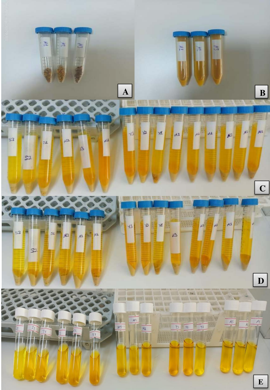
Şekil 3.4. Taze arı polenin ekstraksiyon işlemi: A: Tartılan örnekler, B: Homojenize edilen örnekler, C: İlk santrifüjünden sonra örnekler, D: İkinci santrifüjünden sonra örnekler; E: Ekstraktları edilen örnekler
