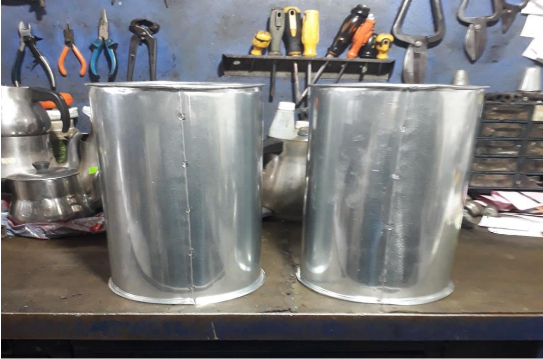
Resim 8. Sütün miktarını ölçmek için kullanılan süt ölçeği.
