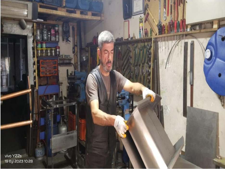
Resim 20. Ramazan Ustanın ürettiği sergen sobanın fırını.
