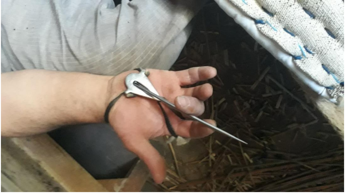
Resim 6. Yörede palan dikmek için kullanılan kefik (kefene).
