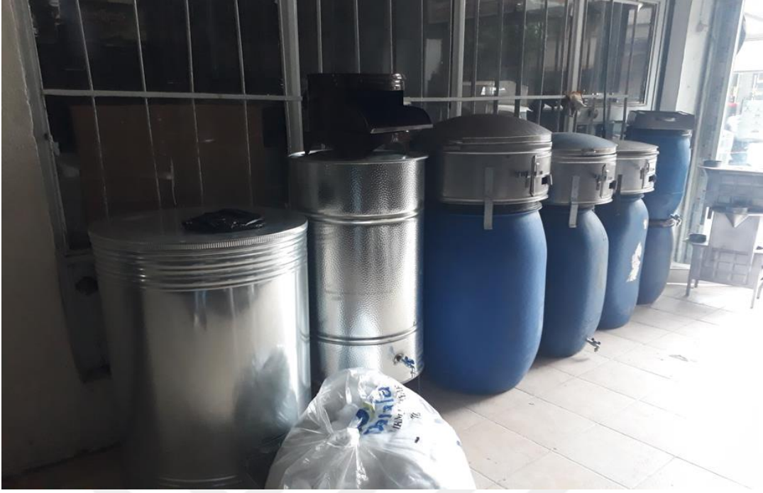
Resim 7. Teneke sacından üretilen ekmek ve banyo sobaları.
