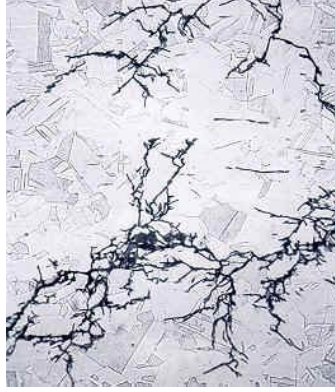
Şekil 2.15 AISI 316 östenitik paslanmaz çelikteki gerilmeli tanelerarası çatlak korozyonu (İnt Ky.6).
