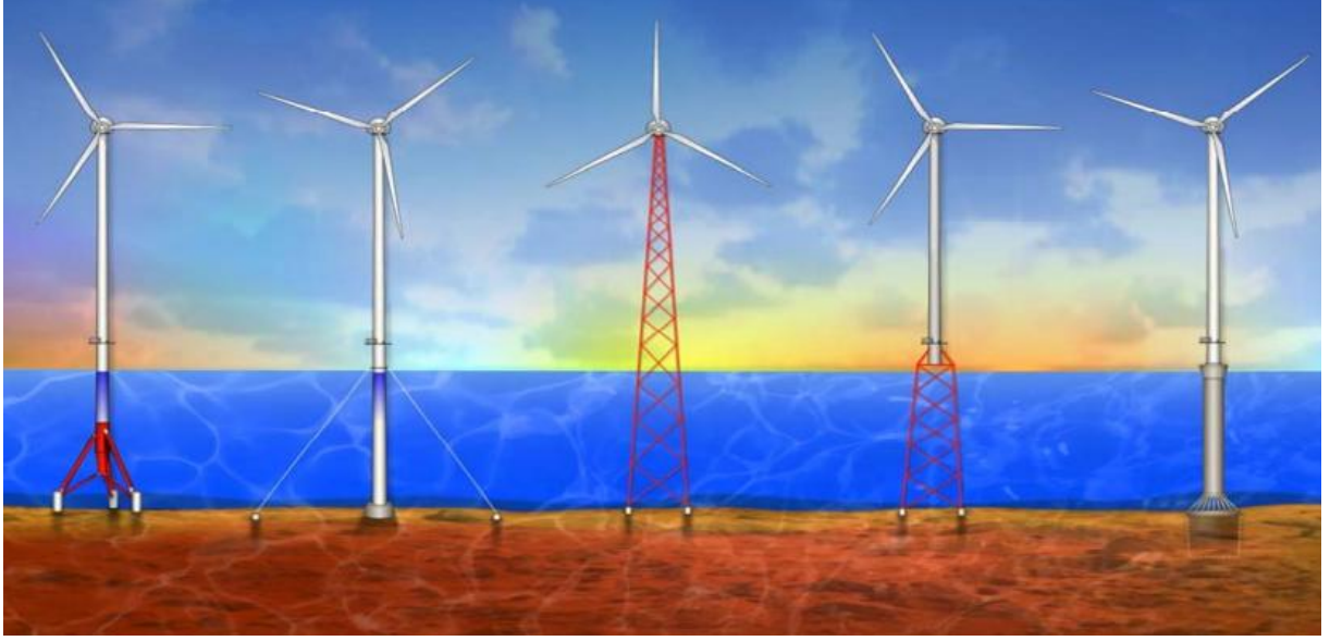
Şekil 2.4: Deniz tabanına temellendirilmiş açık deniz rüzgar türbini kavramsal tasarımları (Robinson ve Musial 2006)
