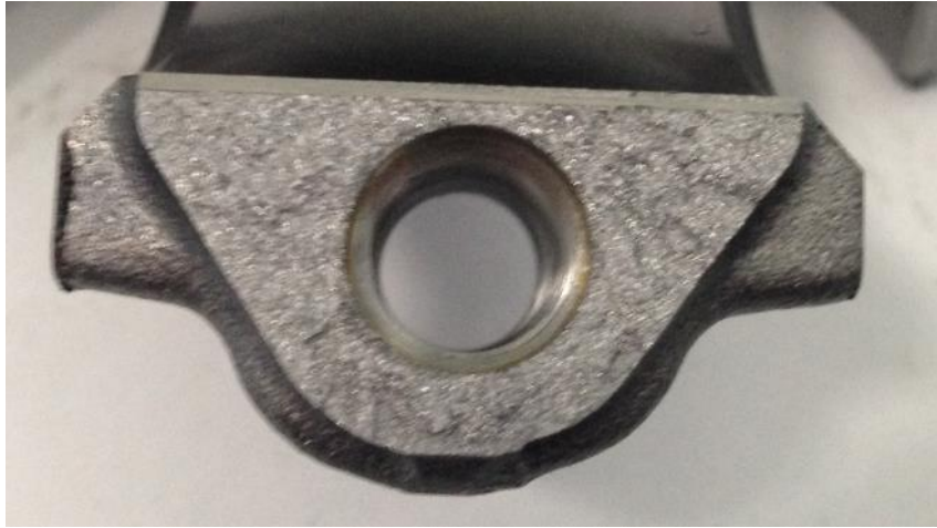
Şekil 5.24 : B10O kırılma sonrası yüzey fotoğrafı.
