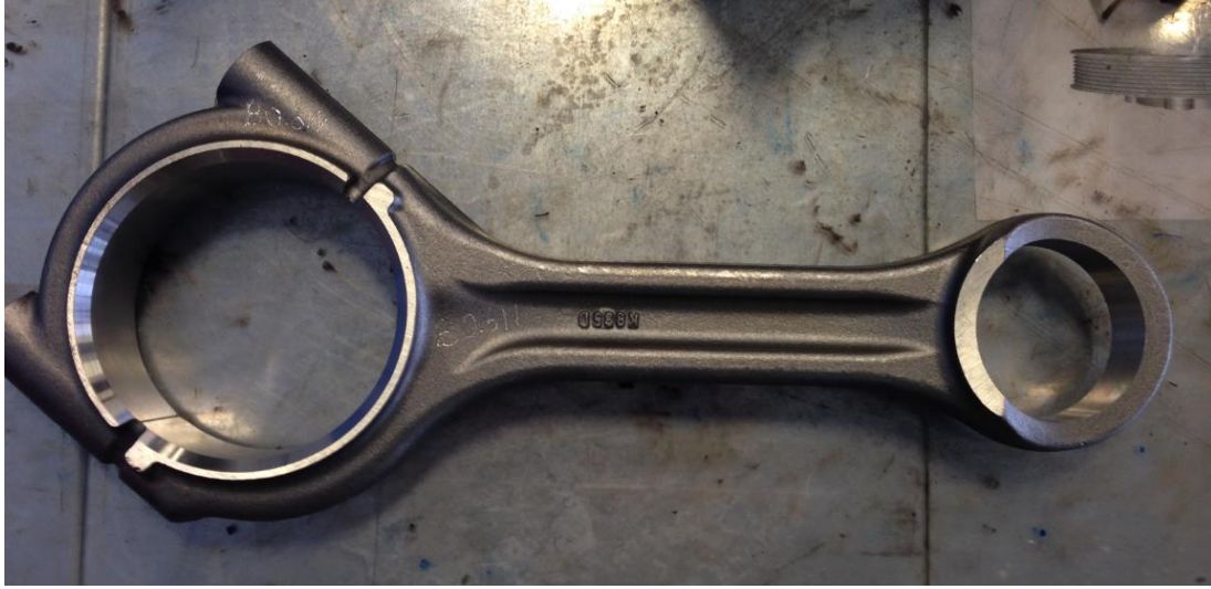
Şekil 4.1 : Tek parça üretilen ve üzerinde çalışılan biyel kolu.
