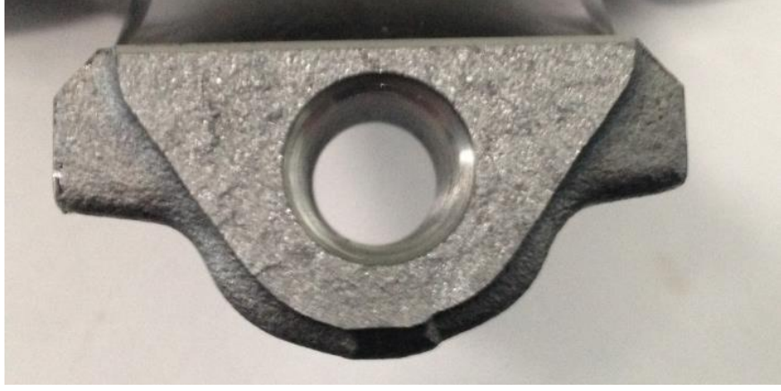
Şekil 5.22 : B6O kırılma sonrası yüzey fotoğrafı.
