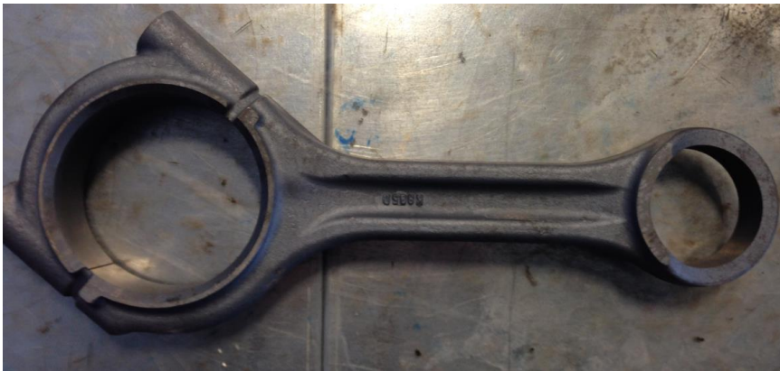
Şekil 4.13 : 450 °C’de temperlenen biyel kolu.
