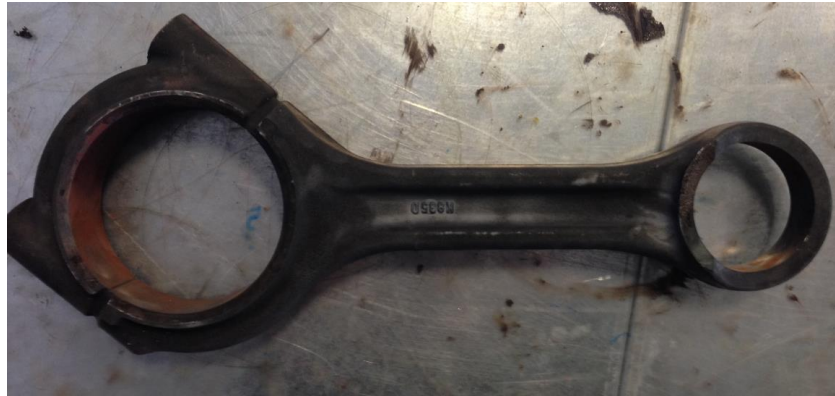
Şekil 4.11 : Gerilim giderme uygulanmış biyel kolu.
