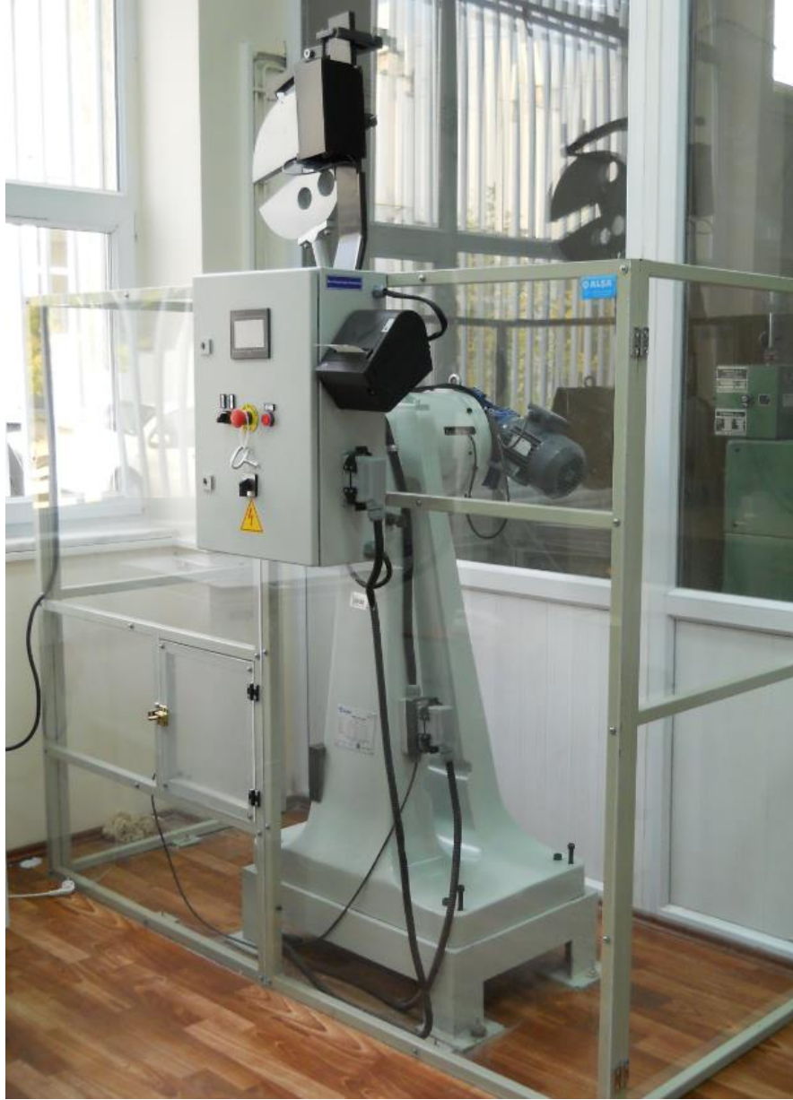
Şekil 5.20 : Alşa çentik darbe test cihazı.
