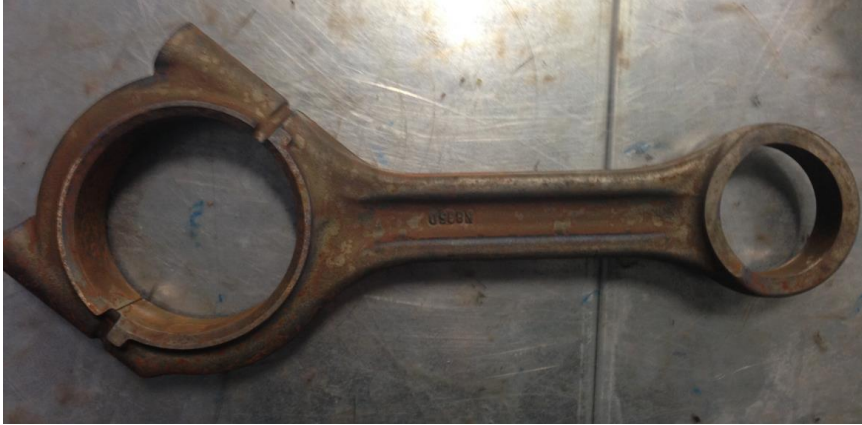
Şekil 4.12 : 180 °C’de temperlenen biyel kolu.
