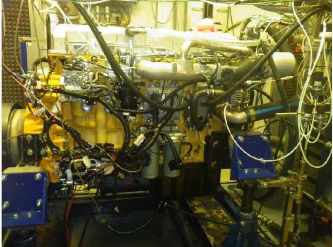
Şekil 5.74 : Seçilen yöntemle imal edilmiş biyel kolu ile koşulan dinamometre motoru ömür testi.
