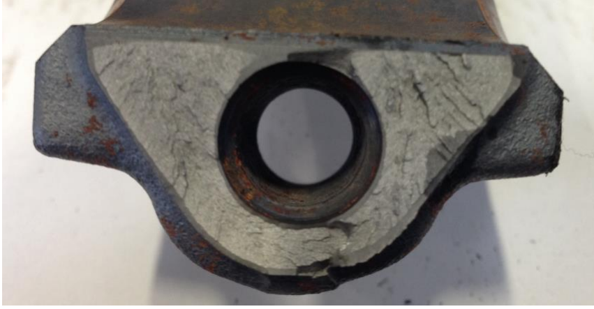
Şekil 5.37 : B10T2 kırılma sonrası yüzey fotoğrafı.
