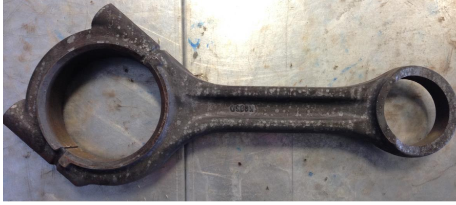
Şekil 4.14 : 620 °C’de temperlenen biyel kolu.
