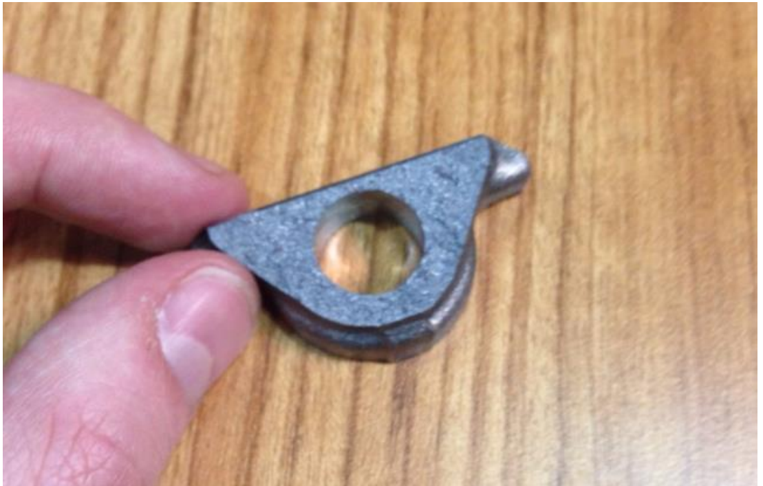
Şekil 5.11 : Elektron mikroskobu görüntüsü için çıkartılan numune örneği.
