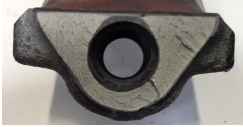
Şekil 5.40 : B8T3 kırılma sonrası yüzey fotoğrafı.
