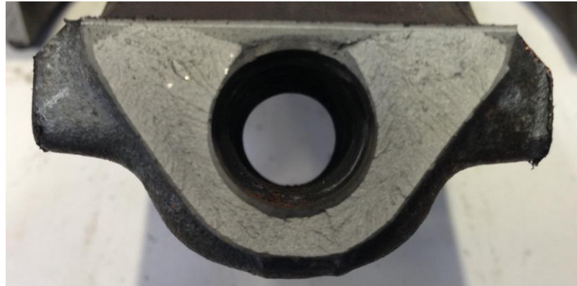
Şekil 5.42 : L6T3 kırılma sonrası yüzey fotoğrafı.
