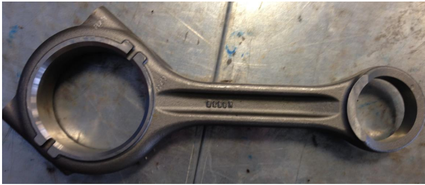
Şekil 4.17 : Dövme sonrası kırılmaya hazır kalın kesitli biyel kolu.
