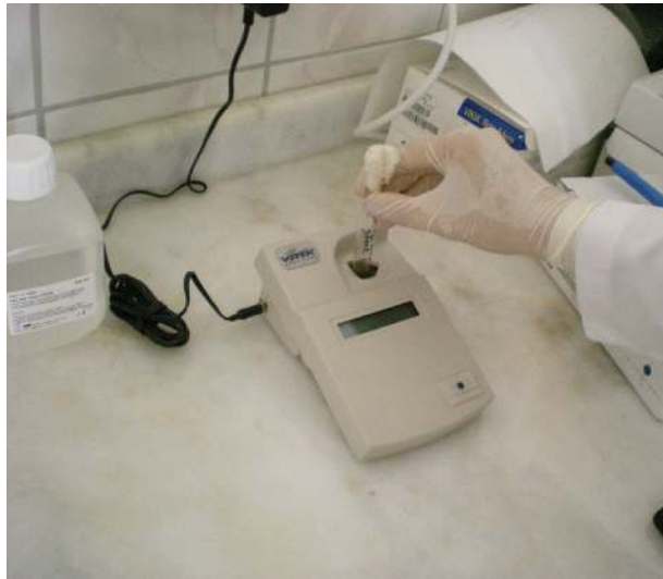
Resim 8: 0,5 McFarland ( 1,5 \times 10^8 cfu/ml) yoğunlukta mikroorganizma eldesi
