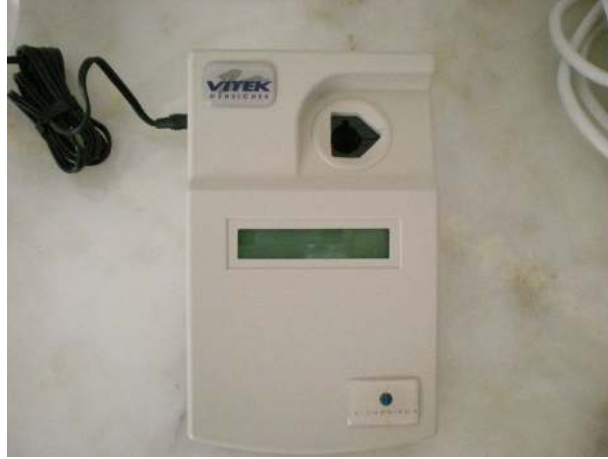
Resim 7: VITEK Densitrek markalı yoğunluk ayar cihazı
