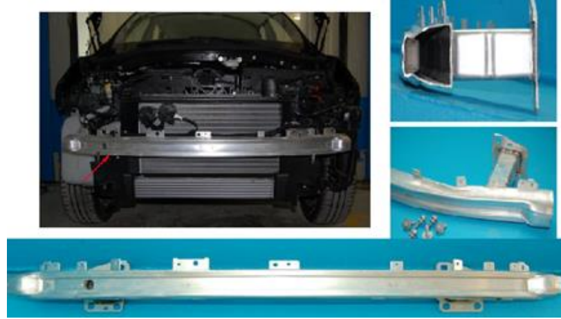
Şekil 4.5: Benchmark yapılan aracın tampon, çarpma kutusu ve ana ray gösellersi
