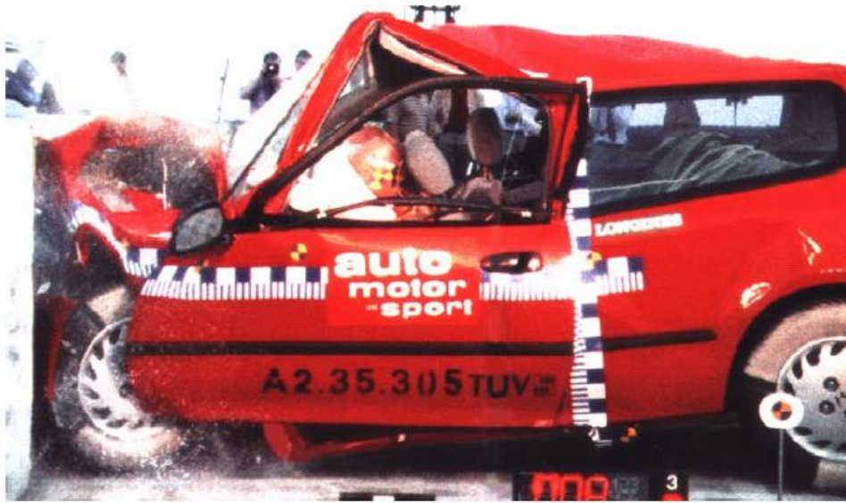
Şekil 2.1: 55km/saat hız ile aracın önden çarpması sırasında yolcu kompartmanında meydana gelen büyük deformasyon (Auto Motor und Sport spezial 1992, photo H.P. Seufert)[8]
