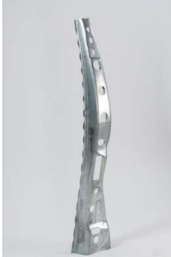
Şekil 2.5: DP 980 çeliğin B pillar desteğinde uygulaması[18]
