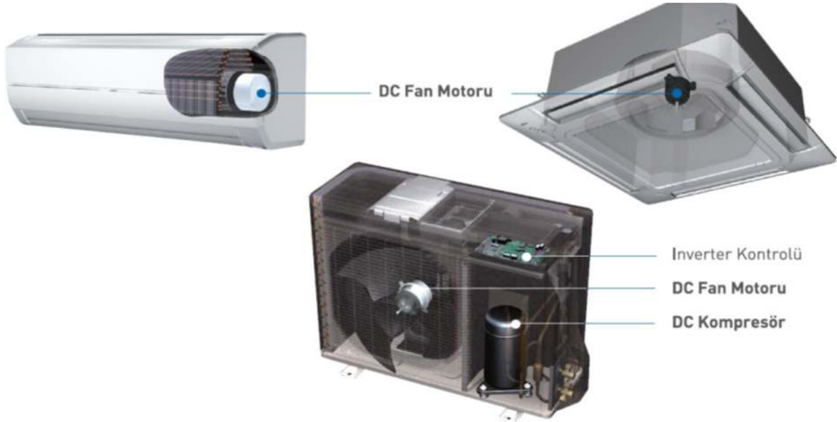
Şekil 3.6. İnverter özellikli DC motor ve kompresör tatbiki [15]
