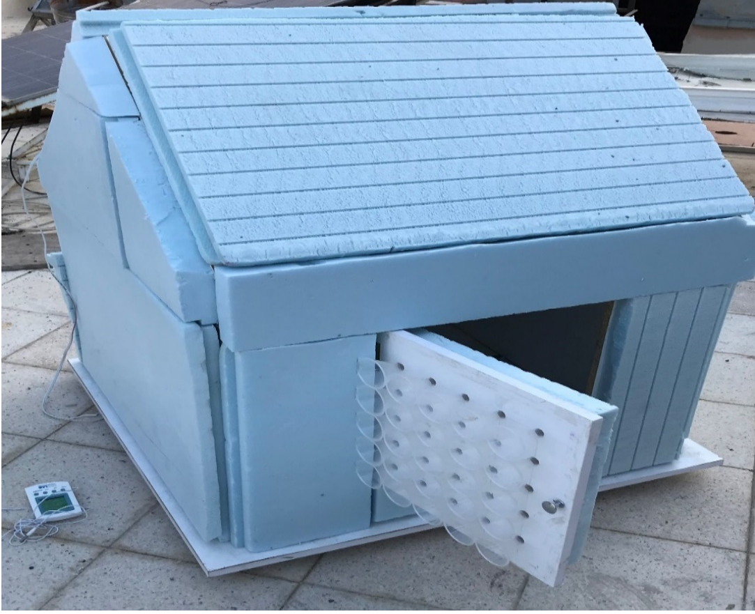
Şekil 4.10. Deney düzeneğinin yalıtımlı hali (a; düzeneğin aspiratörlü tarafı, b; düzeneğin akış lüleli tarafı)
