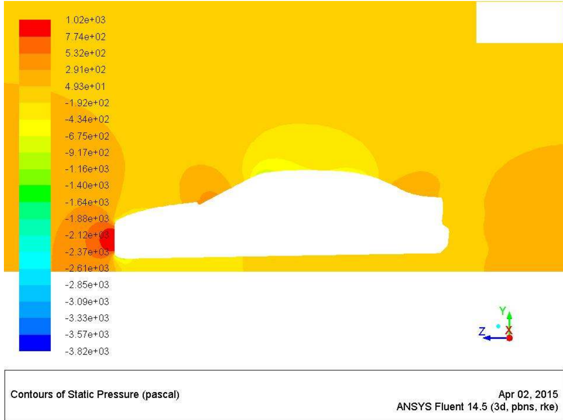
Şekil 3. 11. X=0, simetri eksenini boyunca orijinal araç üzerinde oluşan basınç konturları
