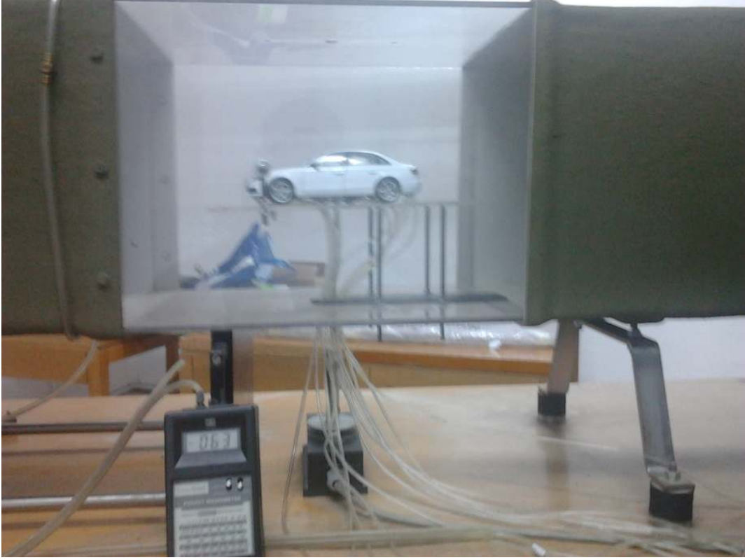
Resim 2. 3. Basınç ölçümü için hortumların modele bağlantısı
