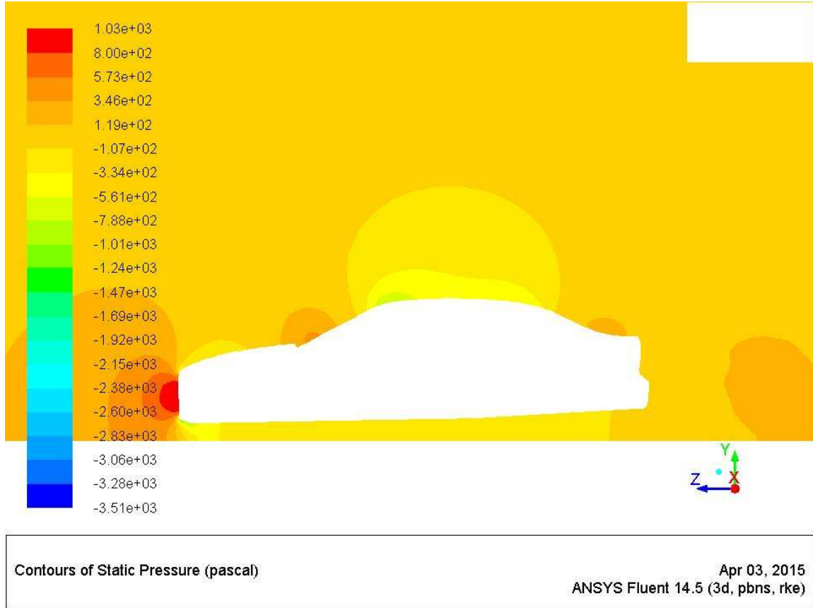
Şekil 3. 12. X=0, simetri eksenini boyuncu yeniden tasarlanan araç üzerinde oluşan basınç konturları
