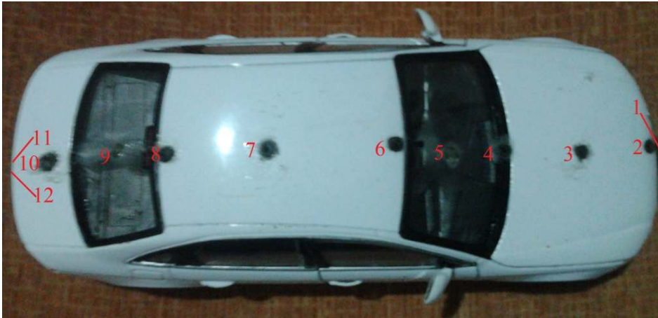
Resim 2. 2. Basınç ölçümü için model üzerine açılan delikler
