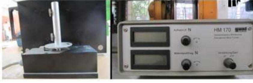
Resim 2. 4. İki eksenli yük hücresi ve amplifikatör
