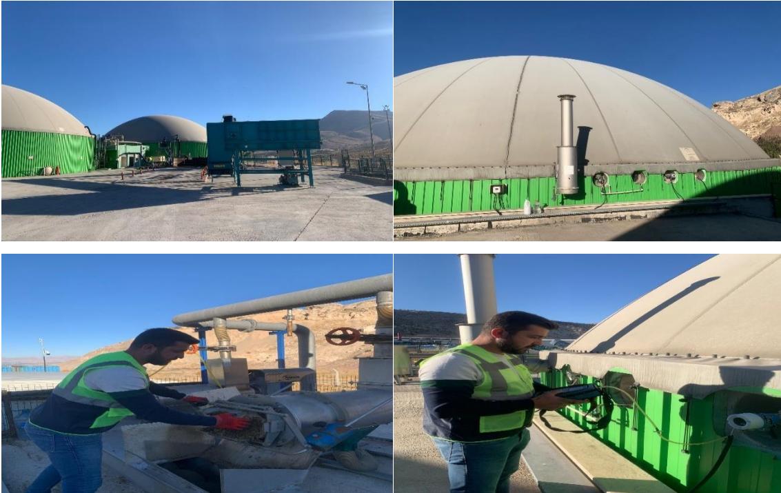
Şekil. 2.1. Biyogaz tesisi, numune alımı ve gaz ölçümleri
