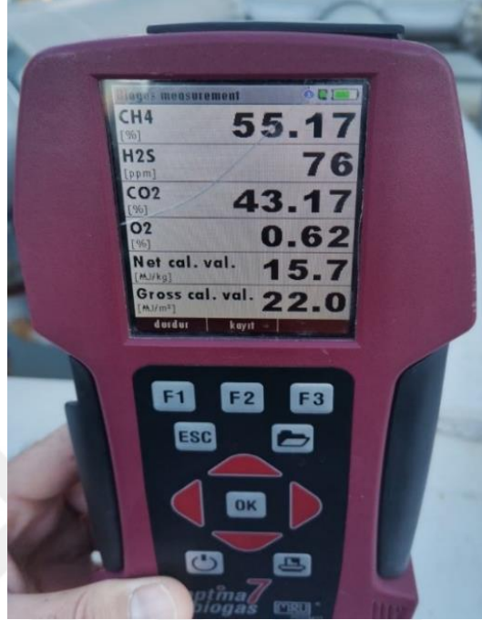
Şekil 6.27. MRU Optima7 gaz ölçüm cihazı ile biyogaz ölçümü
