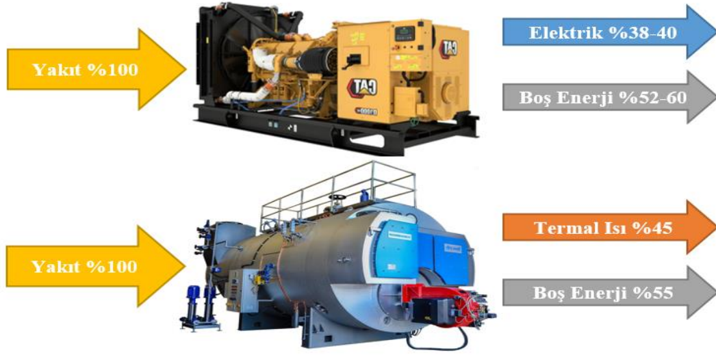
Şekil 4.8. Elektrik ve ısı enerjisi ayrı üretimi
