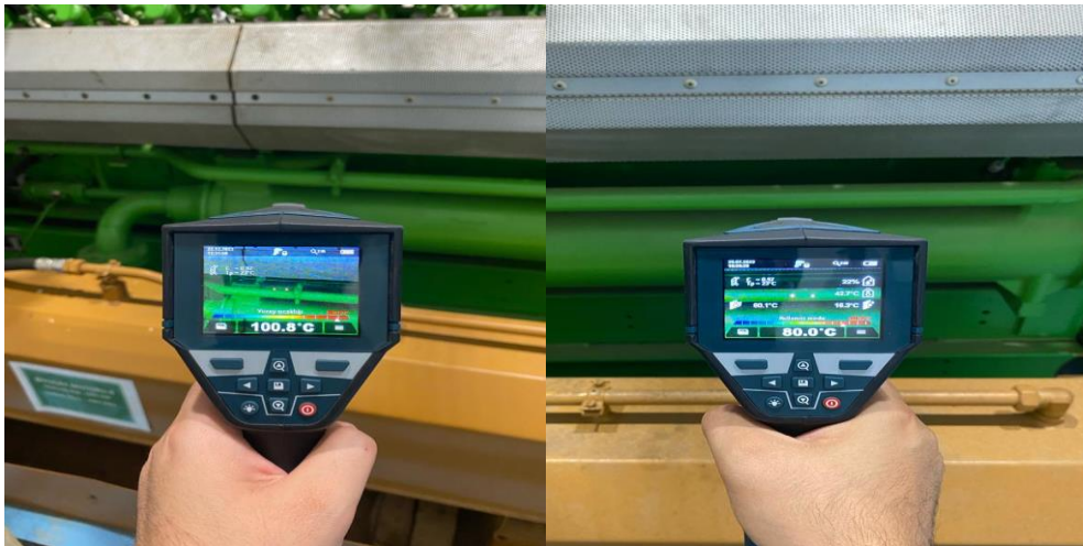
Şekil 6.47. Yağ devresinin motor çıkış sıcaklığı ve soğutma eşanjörü çıkış sıcaklığı
