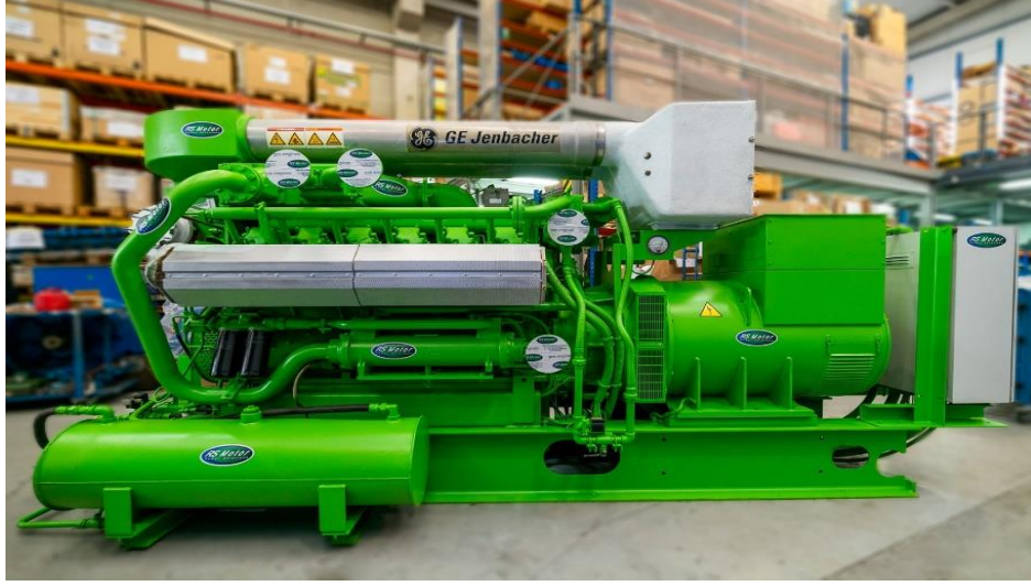
Şekil 4.6. Biyogaz motoru (Jenbacher)
