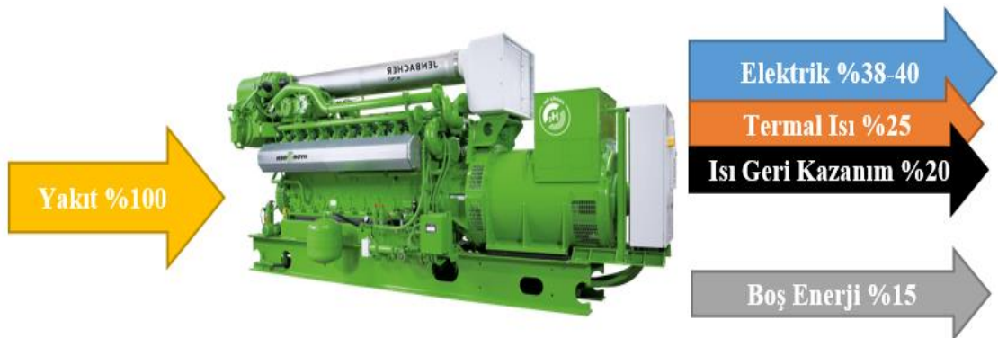
Şekil 4.7. Elektrik ve ısı enerjisi ortak kojenerasyon sistem
