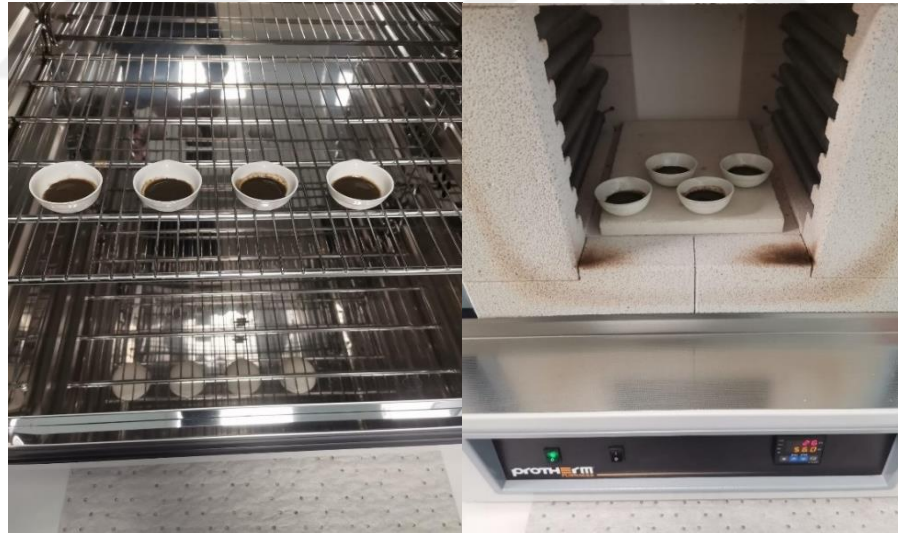
Şekil 6.23. Etüv ve kül fırınında numunelerin hazırlanma
