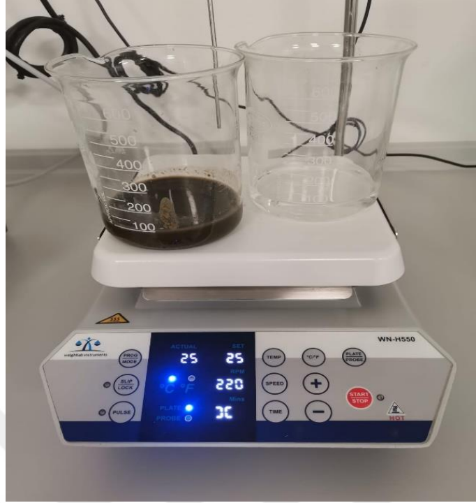
Şekil 6.26. Elektrikli manyetik ısıtıcı ile gübre özgül ısı tayini düzeneği
