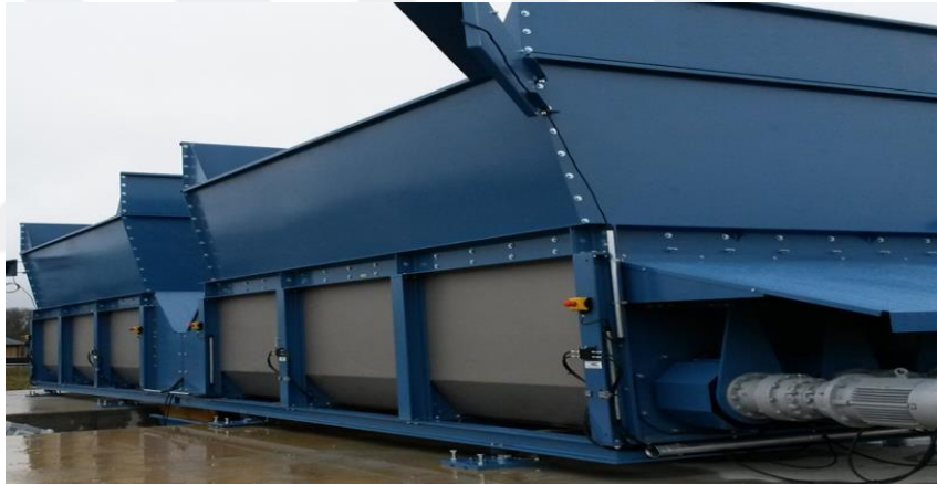
Şekil 4.1. Katı atık besleme ünitesi (Hochreiter)
