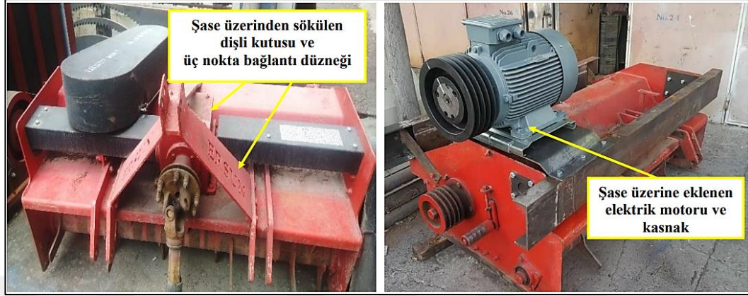
Şekil 3.3. Budama artığı parçalama makinası üzerinde yapılan değişiklikler
