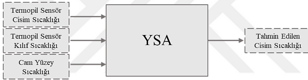
Şekil 70. Geliştirilen ölçüm algoritmasına eklenecek yapay sinir ağının girdi ve çıktıları
