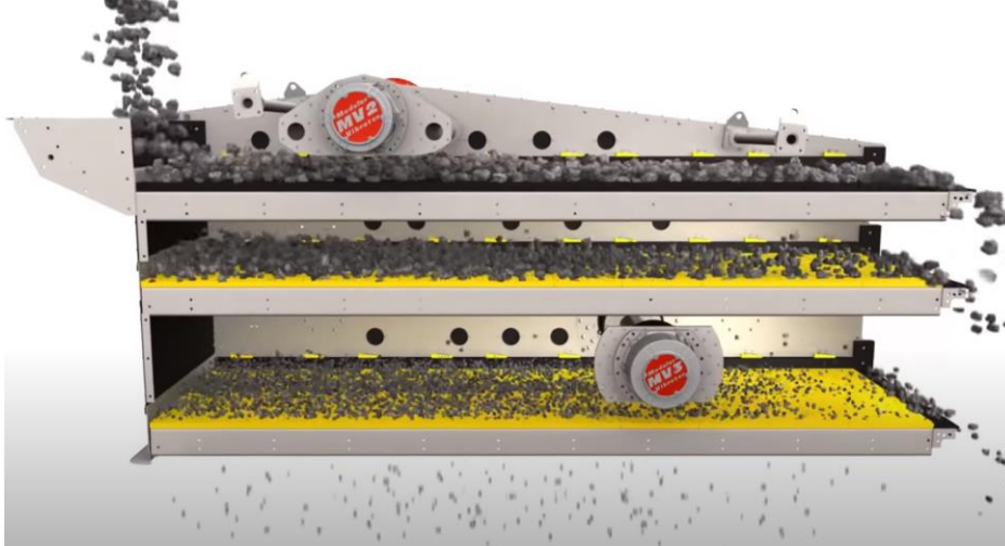
Şekil 11a. Titreşimli elekte elenen cevherler 11
