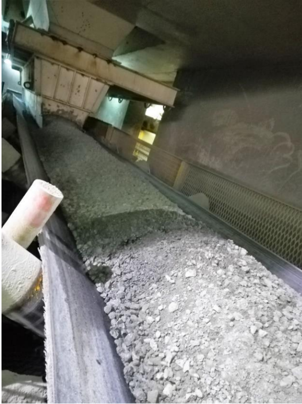
Şekil 33. Öğütmeye uygun boyuta indirgenen cevherler
