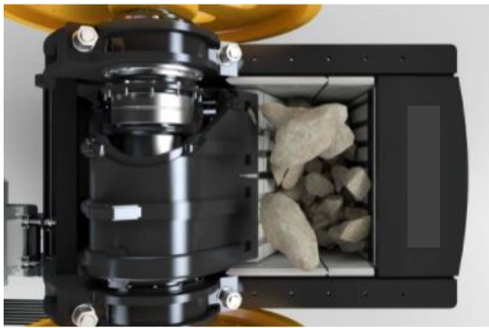
Şekil 4a. Primer çeneli kırıcının cevher beslenmiş durumdaki üstten görüntüsü 7
