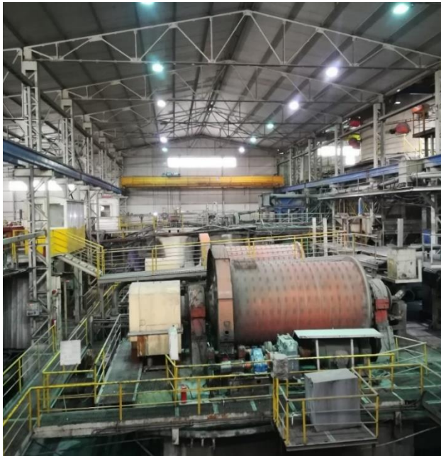
Şekil 6. Bilyeli değirmenlerde cevherin öğütülmesi
