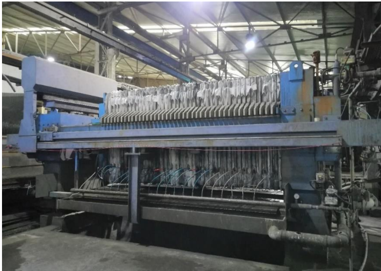
Şekil 8. Pres filtreler aracılığıyla cevherin susuzlandırılması
