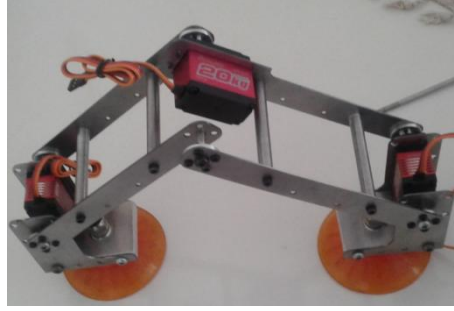
Şekil 3.18. S-Omurgasız Tırmanma Robotu Fiziksel Gerçekleşme 1
