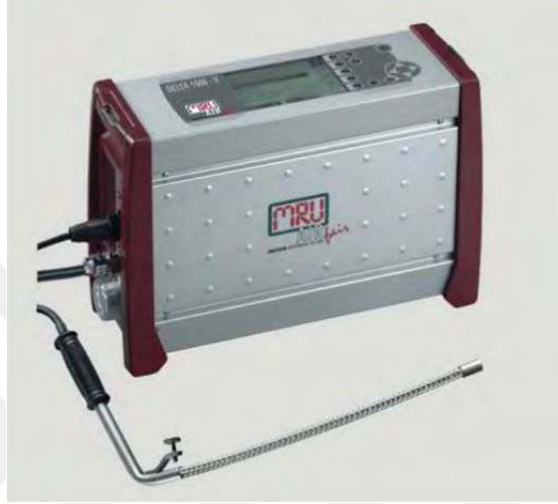
Şekil 3.22. MRU Air Delta 1600 V egzoz gaz analiz cihazı
