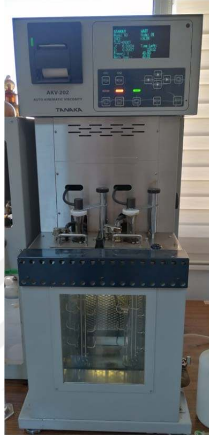
Şekil 3.14. Tanaka AKV-202 kinematik viskozite ölçüm cihazı
