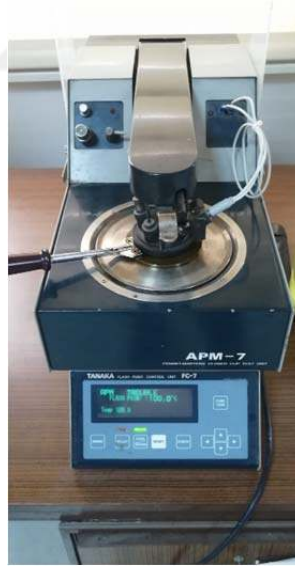
Şekil 3.16. Tanaka Automated Pensky-Martens Closed Cup Flash Point Tester parlama noktası ölçüm cihazı
