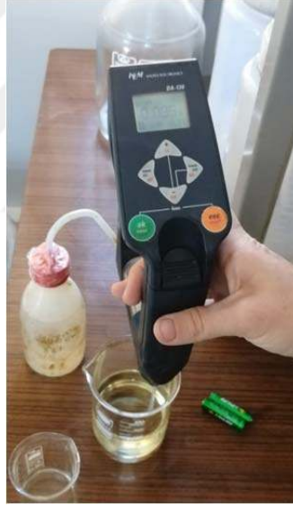
Şekil 3.13. Kyoto Electronics DA-130 portatif yoğunluk ölçer
