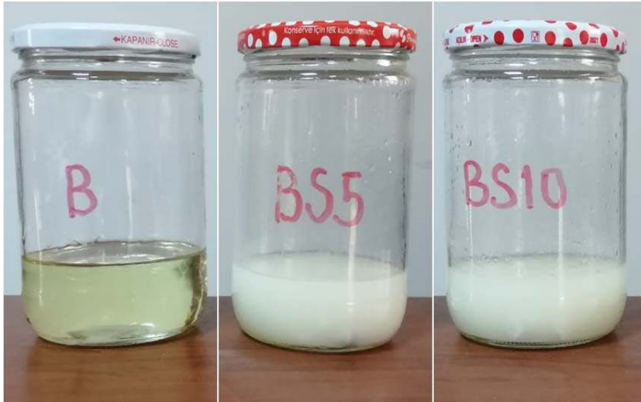
Şekil 3.12. Dizel-su ve biyodizel-su emülsiyon yakıtları
