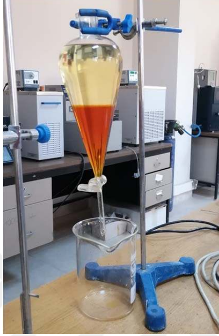
Şekil 3.5. Yoğunluk farkından dolayı ayrılan biyodizel ve gliserin
