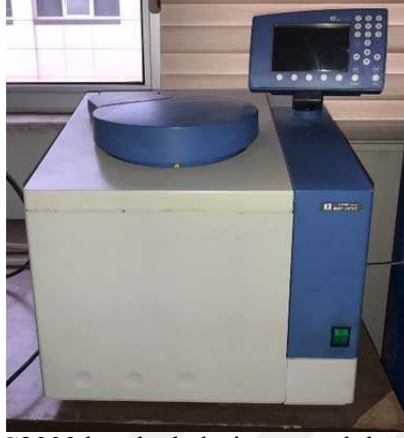
Şekil 3.15. IKA-Werke C2000 bomba kalorimetre ısı değer ölçüm cihazı
