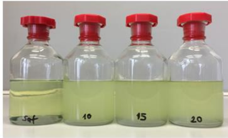
Şekil 3.2. 15.9 °C'lik ortamda E0, E10, E15 ve E20 karışımların 2.dakikadaki fotoğrafı.
