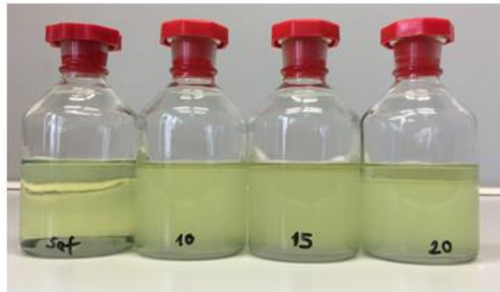
Şekil 3.3. 14 °C'lik ortamda E0, E10, E15 ve E20 karışımların 2.saatteki fotoğrafı.
