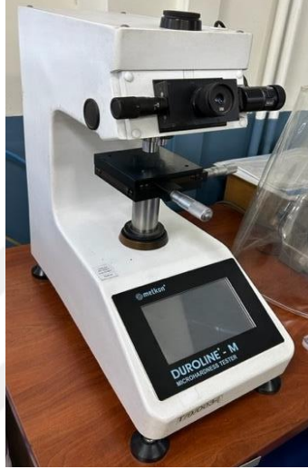
Şekil 3.25.Metkon Duroline-M Mikrovickers Sertlik Ölçüm Cihazı
