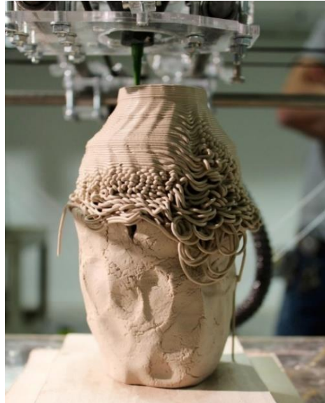
Görsel 2.7 3D printer teknolojisi ile çamurun şekillendirilme anı. ( http-96 )
