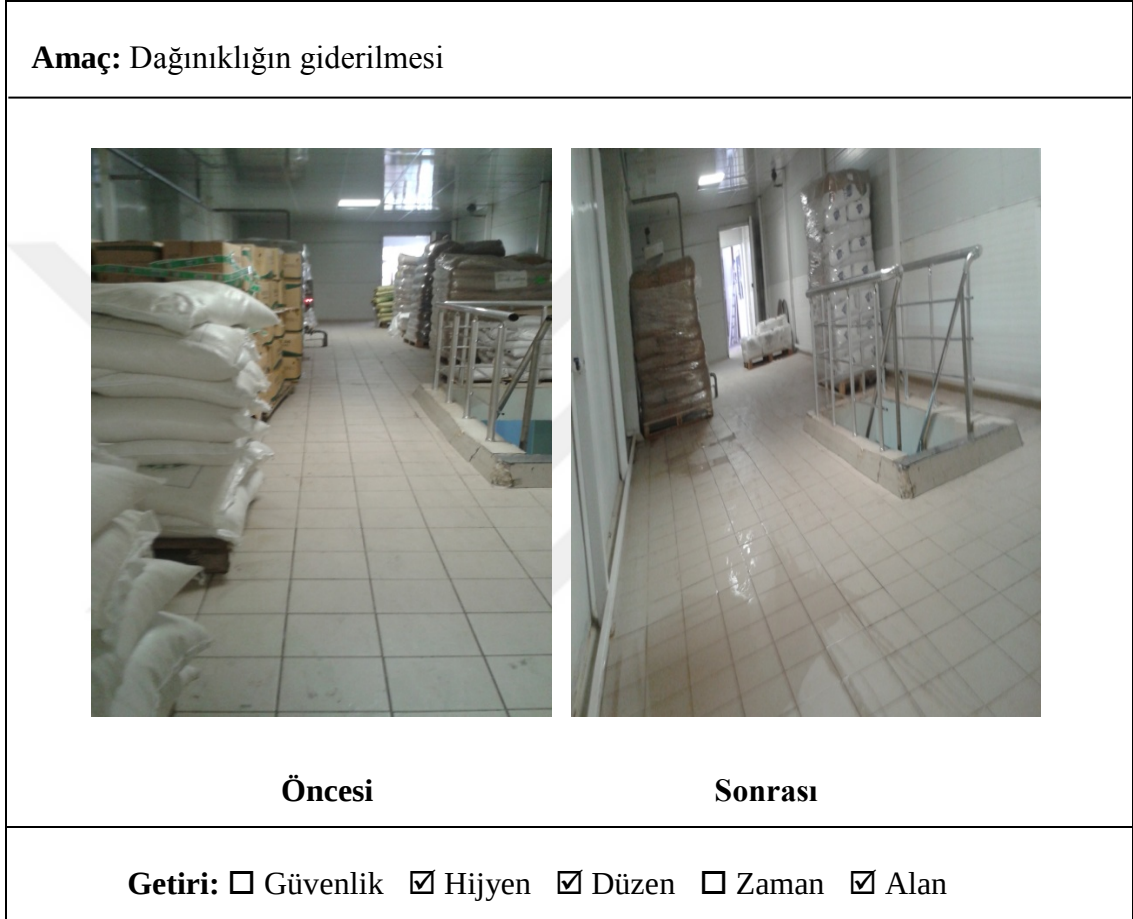
Şekil 2. 27 Malzeme Yerleştirme Kaizeni
