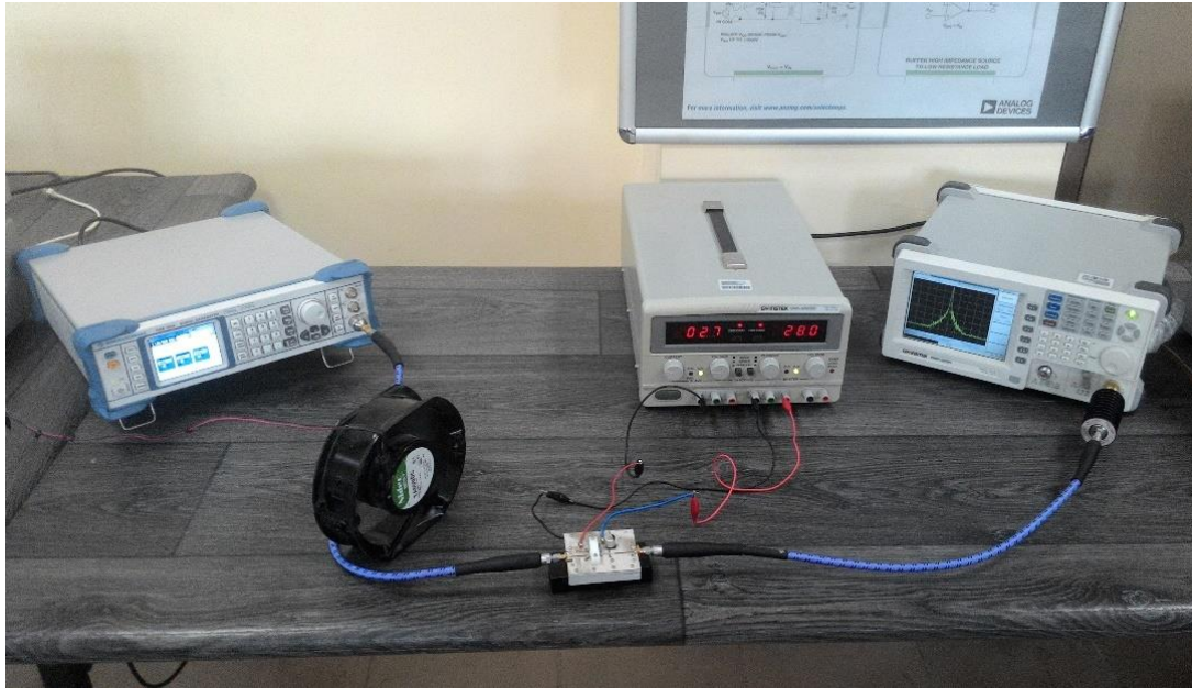
Şekil 5.15 : Prototip yükselteç devresi büyük işaret ölçüm düzeneği.
