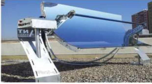
Şekil 1. 4. Parabolik oluklu güneş kolektörü (Rezaeian ve diğerleri., 2021)
