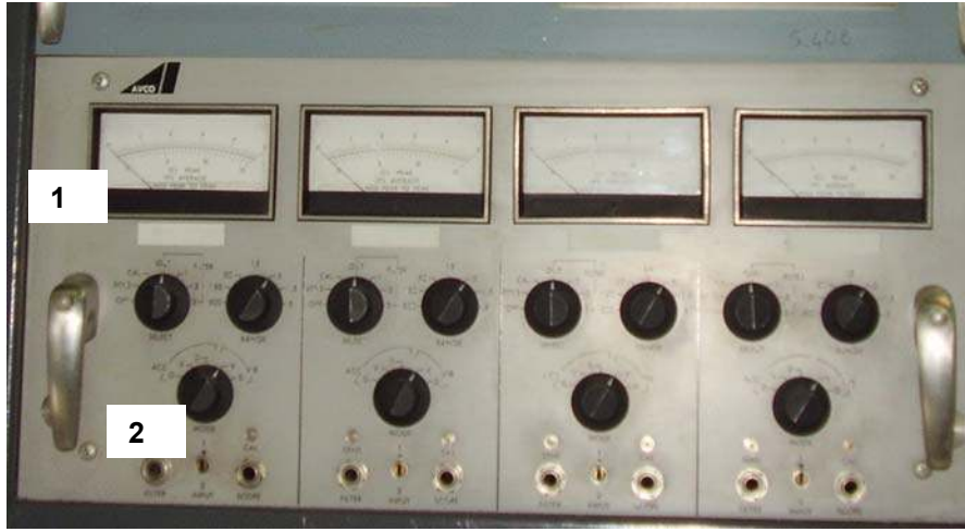
Şekil 3.5. Motor titreşim ölçer modülü 1.Titreşim gösterge modülü 2. Titreşim seviye ayar düğmesi
