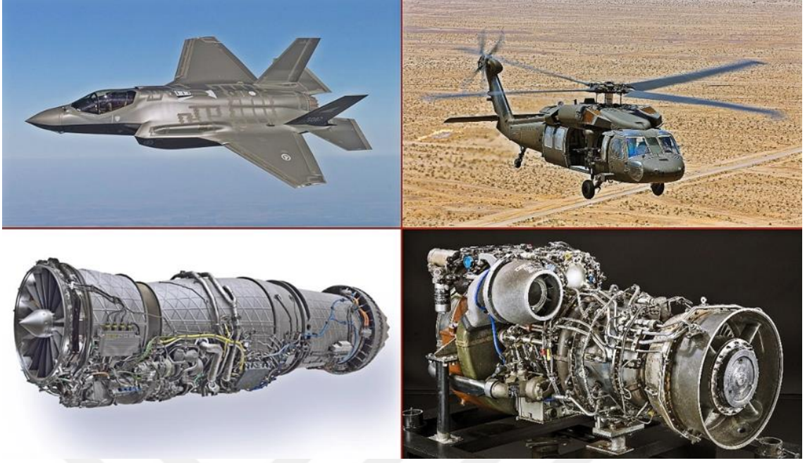
Şekil 3.2. Sol tarafta F35 savaş uçağı ve ona ait bir F135 motorunu, sağ tarafta ise UH60 helikopteri ve ona ait T700 motorunu görmekteyiz. (htpt-2)
