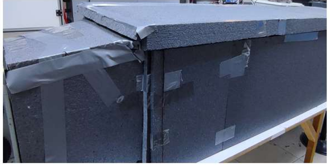
Şekil 5.4. Kanalin EPS ile yalıtımı
