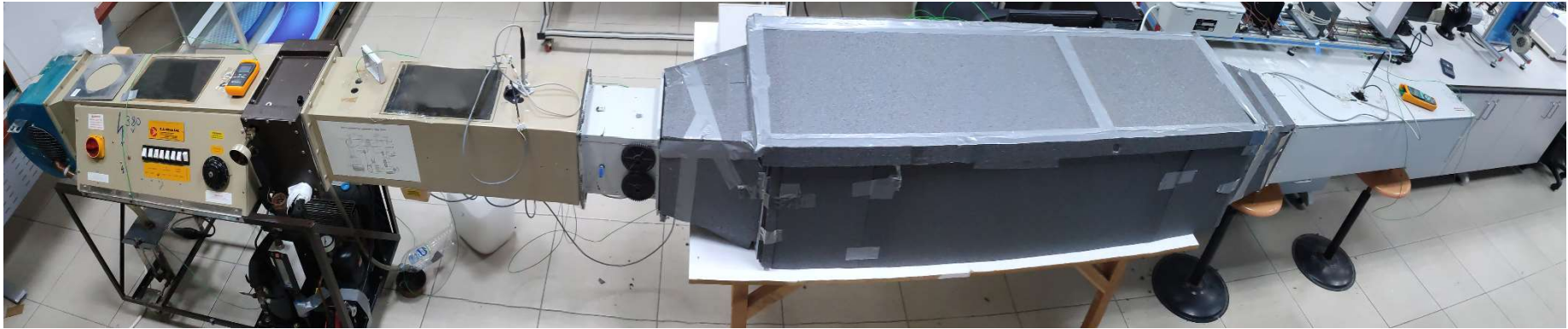
Şekil 5.5. İklimlendirme deney düzeneği ölçüm noktaları
